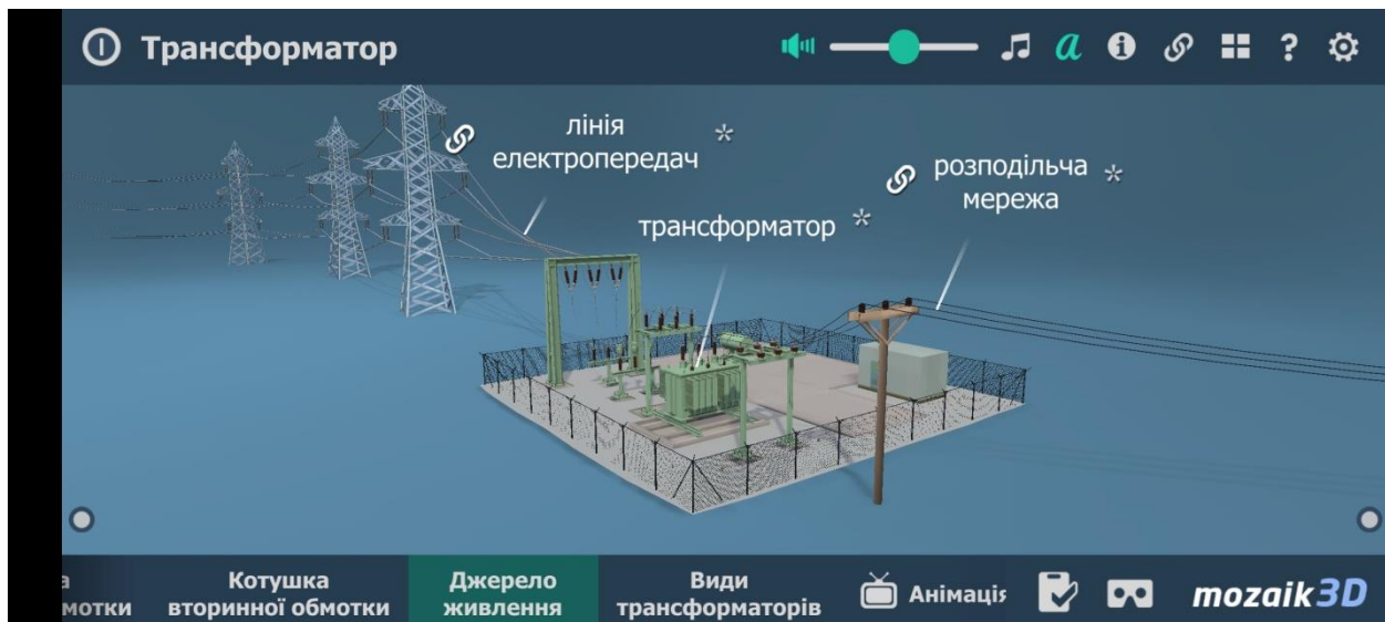
Мал. 6. Практичне застосування силового триобмоткового трансформатора в енергетиці
