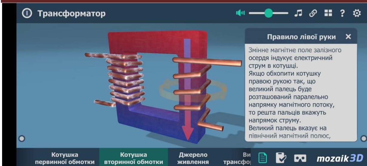
Мал. 5. Можливість повторення правила «лівої руки» за яким електротехнічні процеси відбуваються котушці вторинної обмотки
