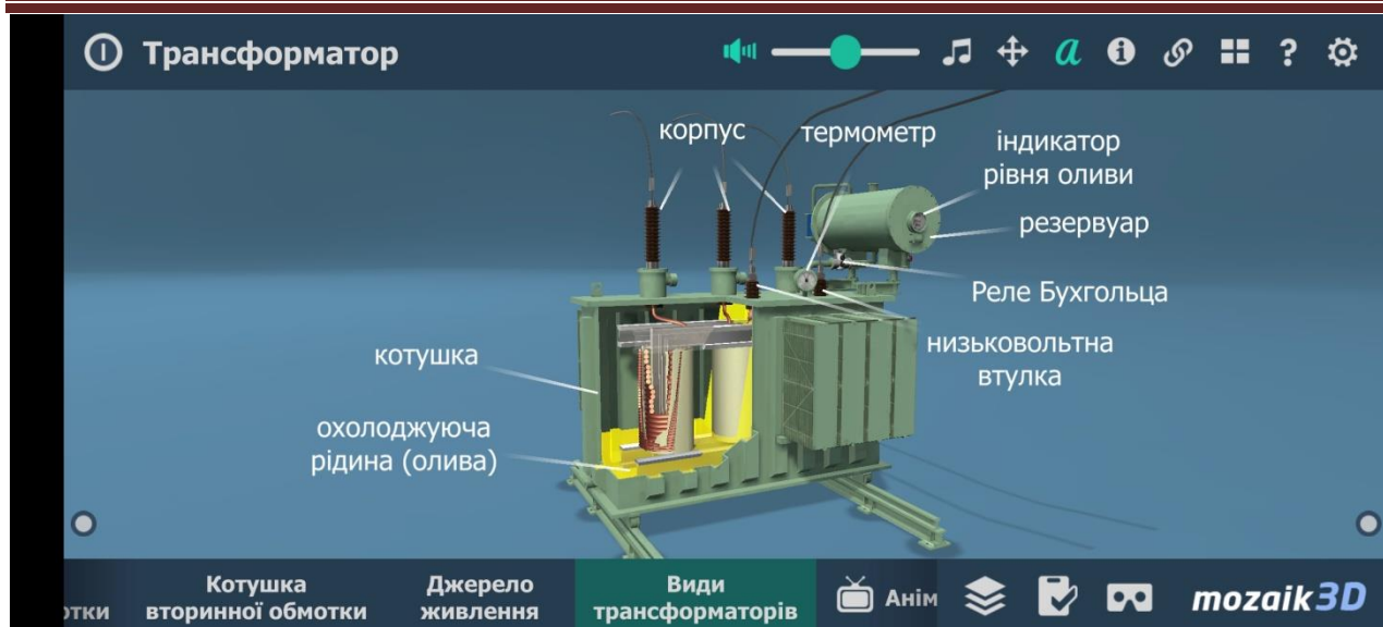
Мал. 7. Будова силового триобмоткового трансформатора
