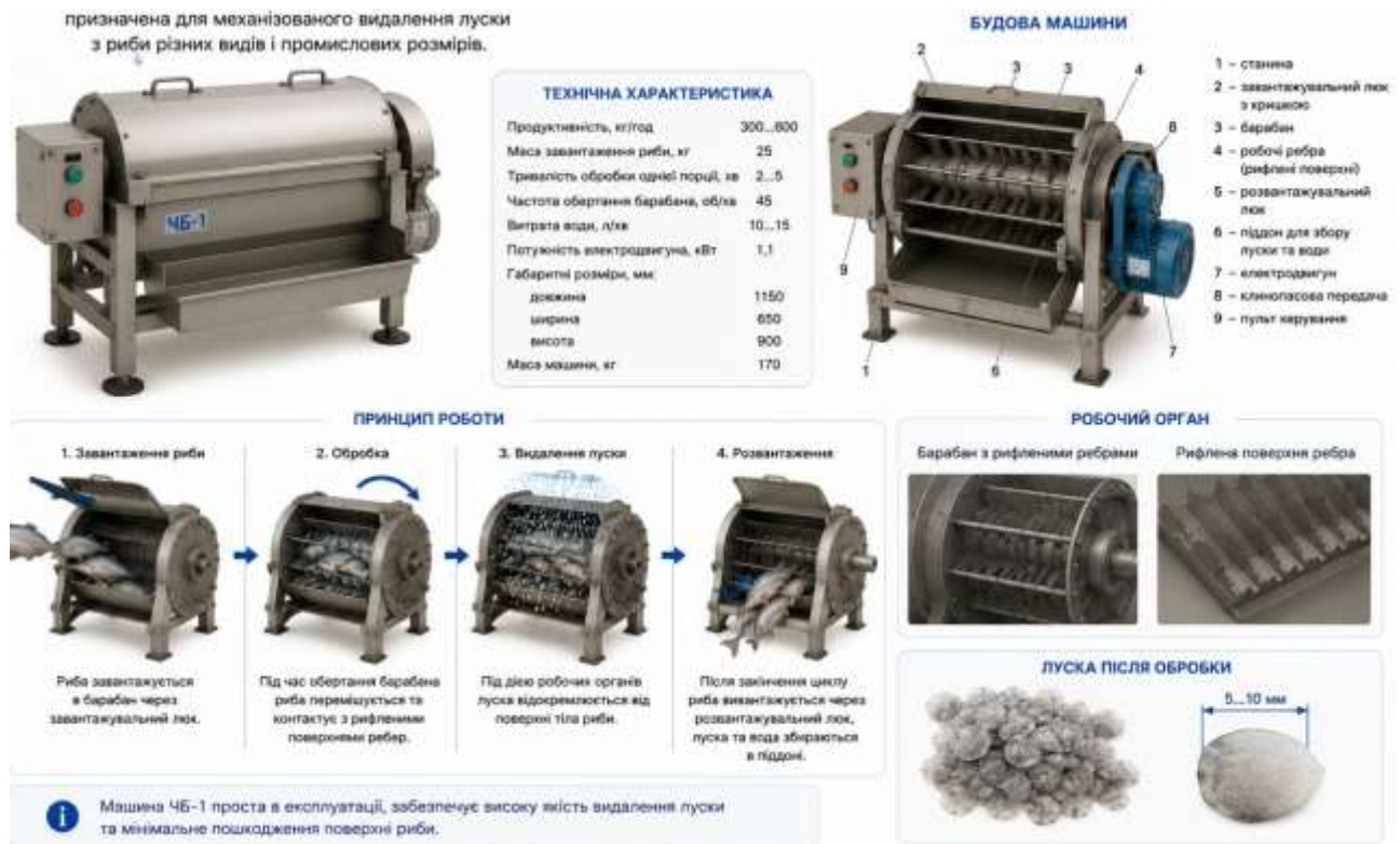
Рис. 8.17. Машина ЧБ-1 барабанного типу для механізованого видалення луски з риби
