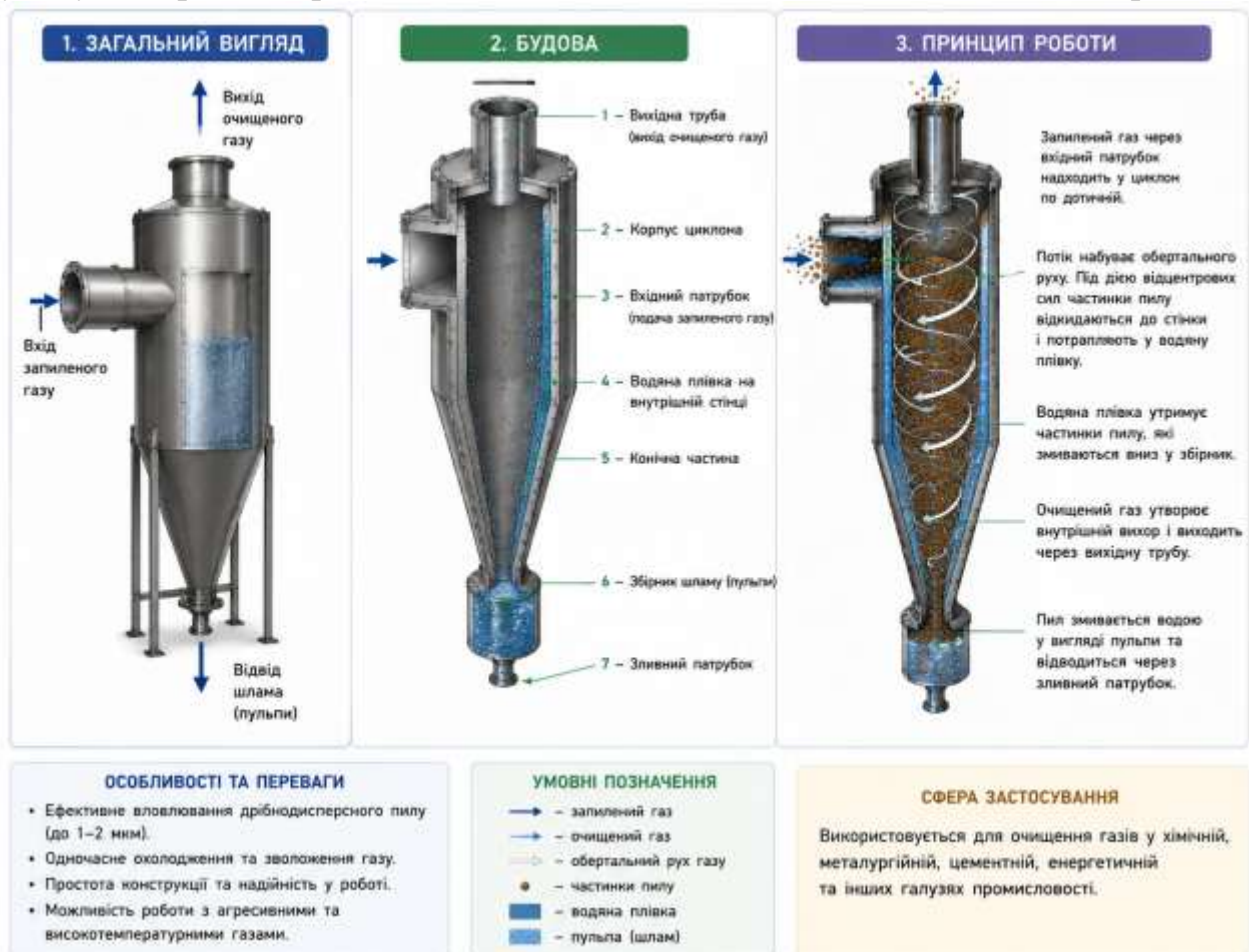
Рис. 11.8. Циклон із водяною плівкою: загальний вигляд, будова та принцип роботи
