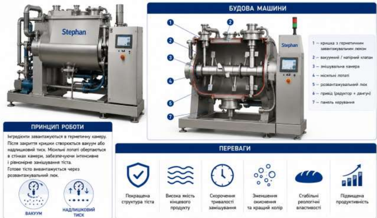
Рис. 10.29. Конструкція та принцип роботи тістомісильної машини «Stephan» («Штефан»)
