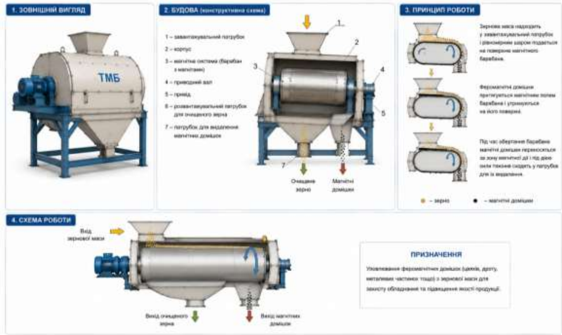
Рис. 7.31. Магнітний уловлювач барабанного типу: зовнішній вигляд, будова та принцип роботи
