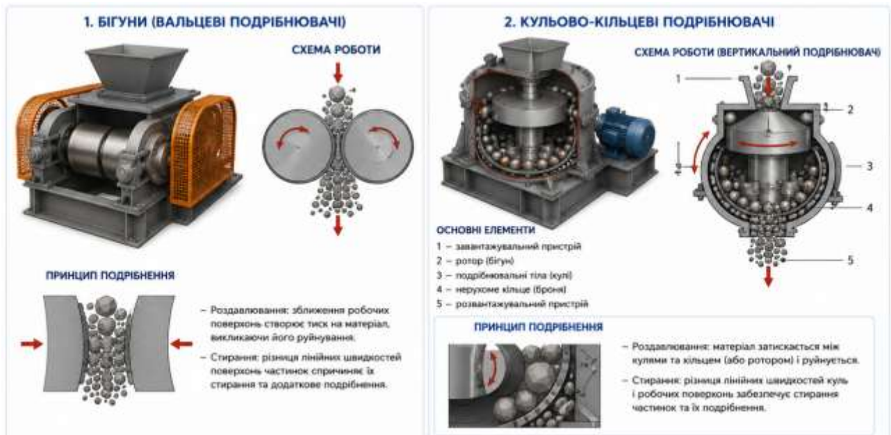
Рис. 9.21. Бігуни та кульово-кільцеві подрібнювачі: конструкція та принцип дії
