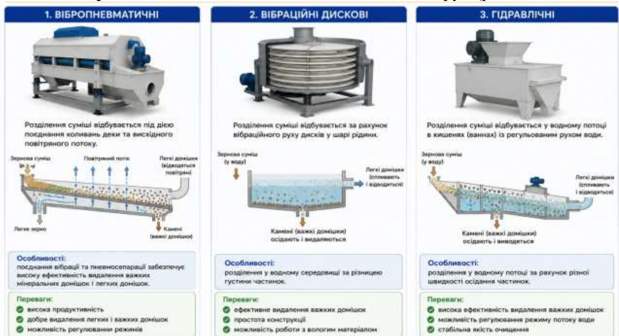
Рис. 7.28. Класифікація каменевідбірних машин за принципом дії та конструктивними особливостями
