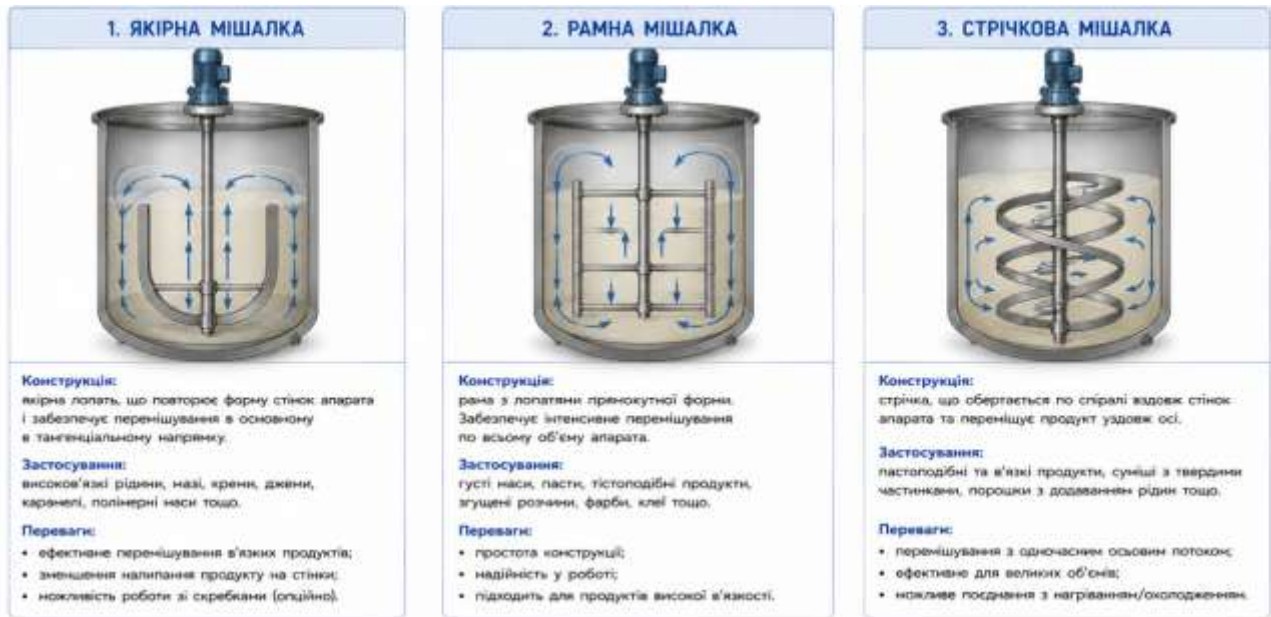
Рис. 10.13. Конструкція та особливості роботи тихохідних мішалок
