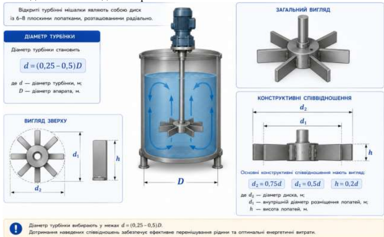
Рис. 10.11. Будова відкритої турбінної мішалки
