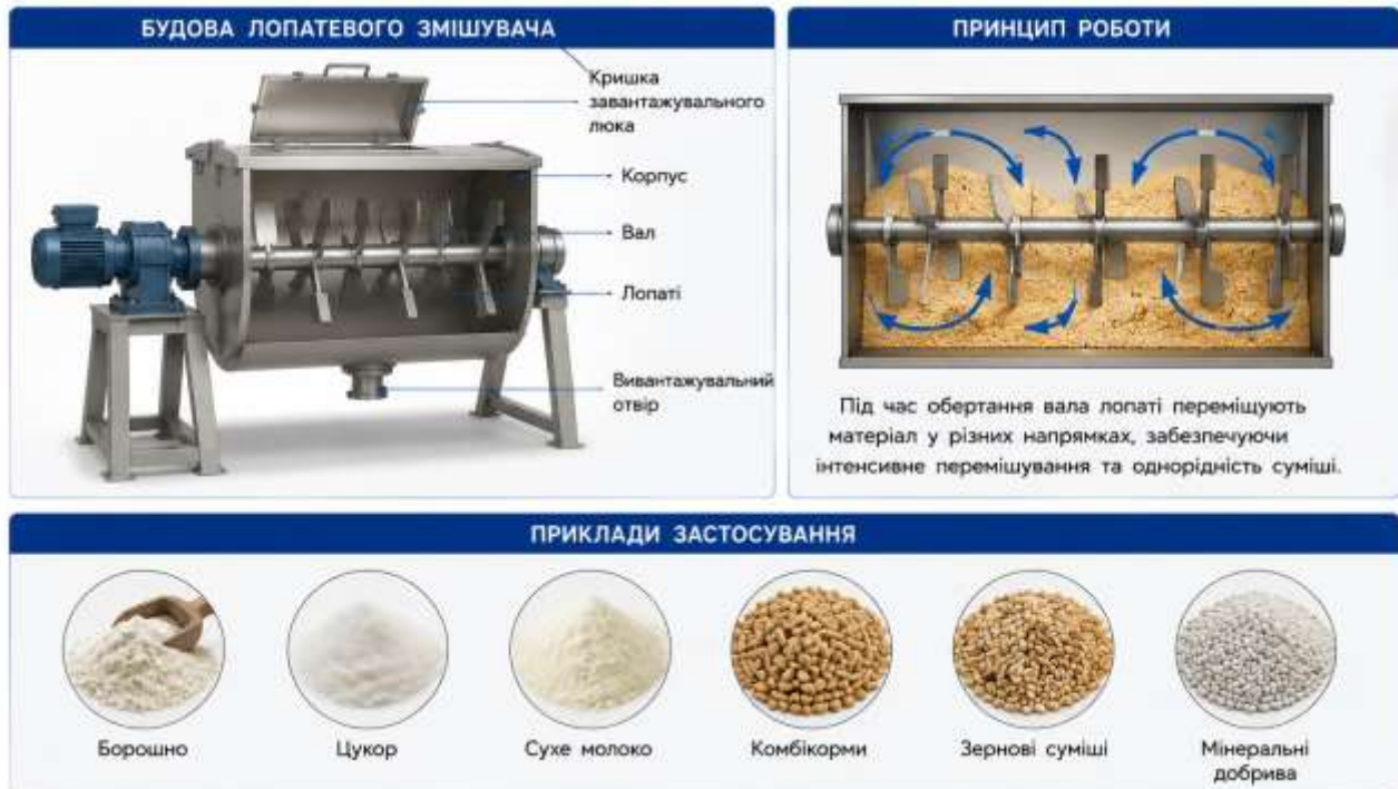
Рис. 10.20. Будова та принцип роботи лопатевого змішувача
