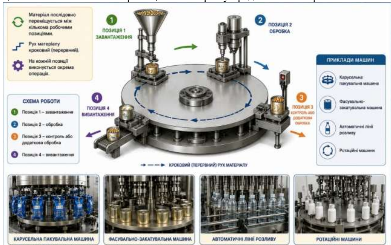
Рис. 2.10. Схема роботи багатопозиційної перервно-поточної машини з циклічним механізмом переміщення матеріалу
