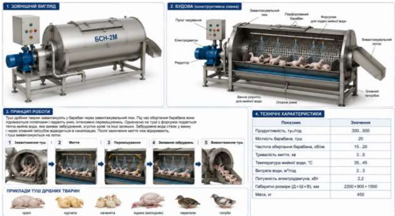
Рис. 6.5. Барабанна мийна машина БСН-2М: зовнішній вигляд, будова та принцип роботи
