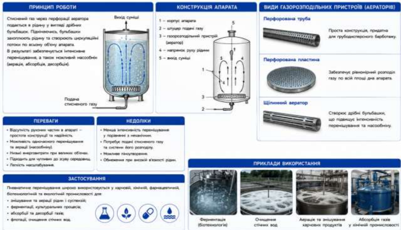
Рис. 10.16. Пневматичне перемішування рідких середовищ
