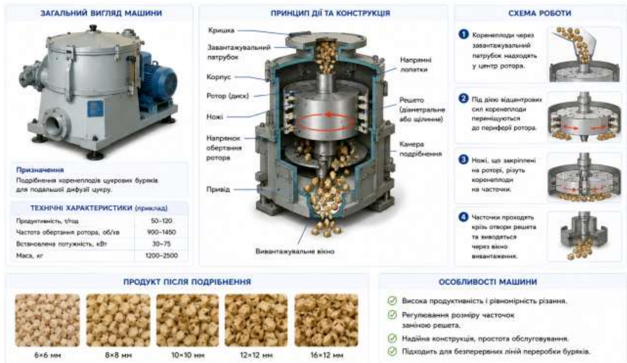
Рис. 9.31. Будова бурякорізки відцентрової дії та схема подрібнення коренеплодів
