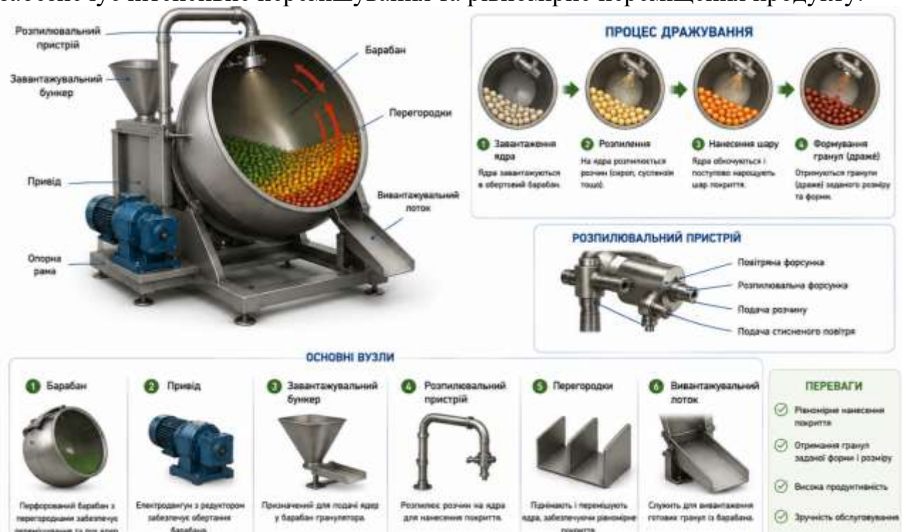
Рис. 13.17. Дражувальний гранулятор: конструкція та принцип роботи
