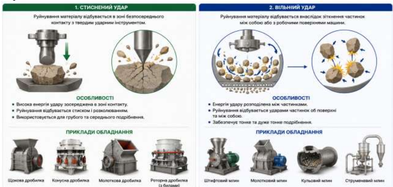
Рис. 9.6. Способи подрібнення матеріалів ударом
