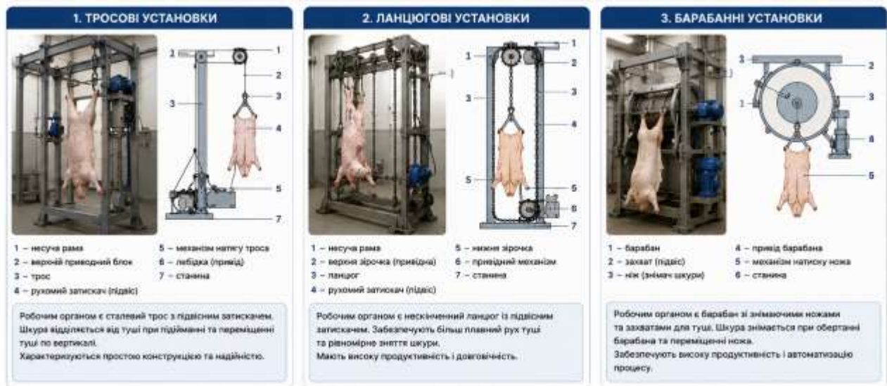
Рис. 8.2. Класифікація установок для зняття шкур за конструкцією робочих органів
