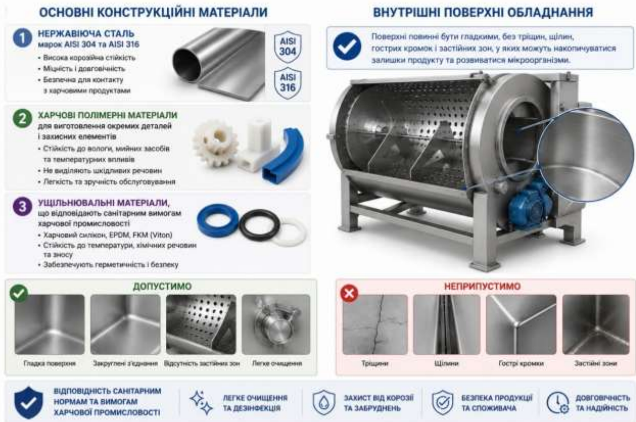
Рис. 6.8. Конструкційні матеріали та санітарно-гігієнічні вимоги до барабанних мийних машин
