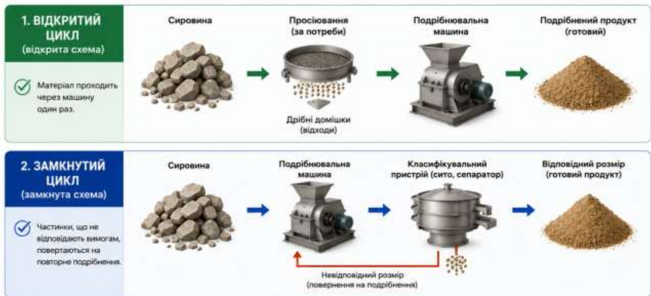
Рис. 9.10. Технологічні схеми процесу подрібнення у відкритому та замкнутому циклах
