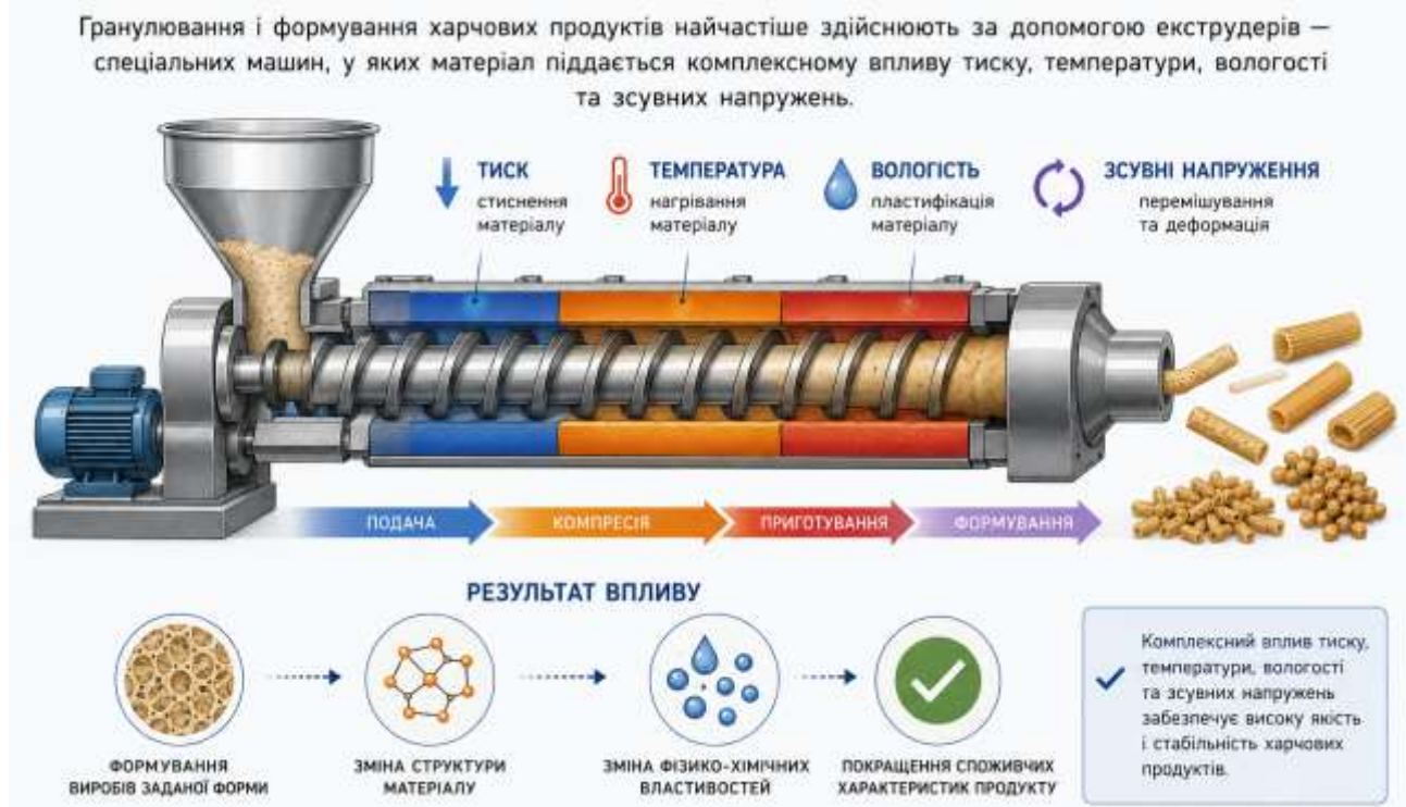
Рис. 13.5. Екструдер у харчових технологіях та принцип його роботи
