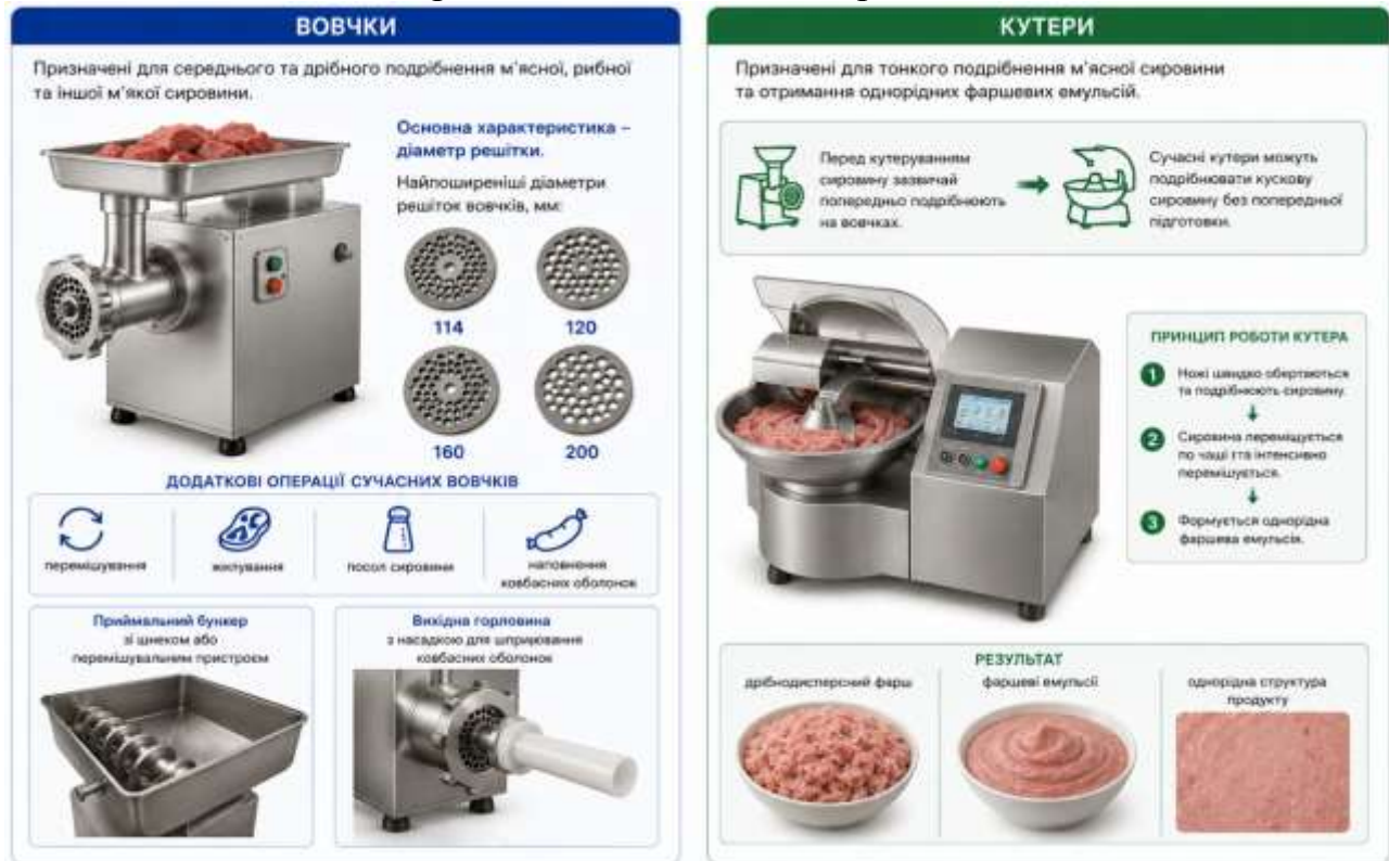
Рис. 9.12. Вовчки та кутери для подрібнення м'ясної і рибної сировини
