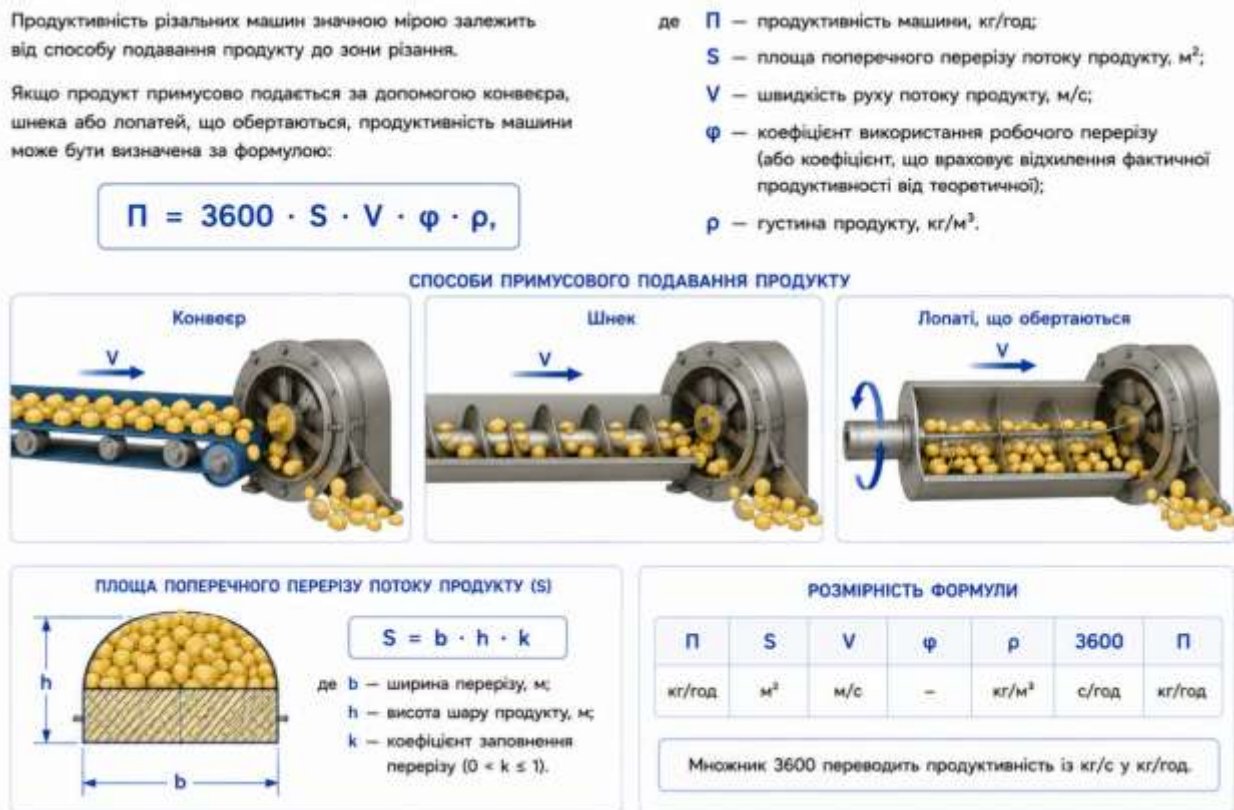
Рис. 9.39. Схема визначення продуктивності різальних машин із примусовим подаванням продукту
