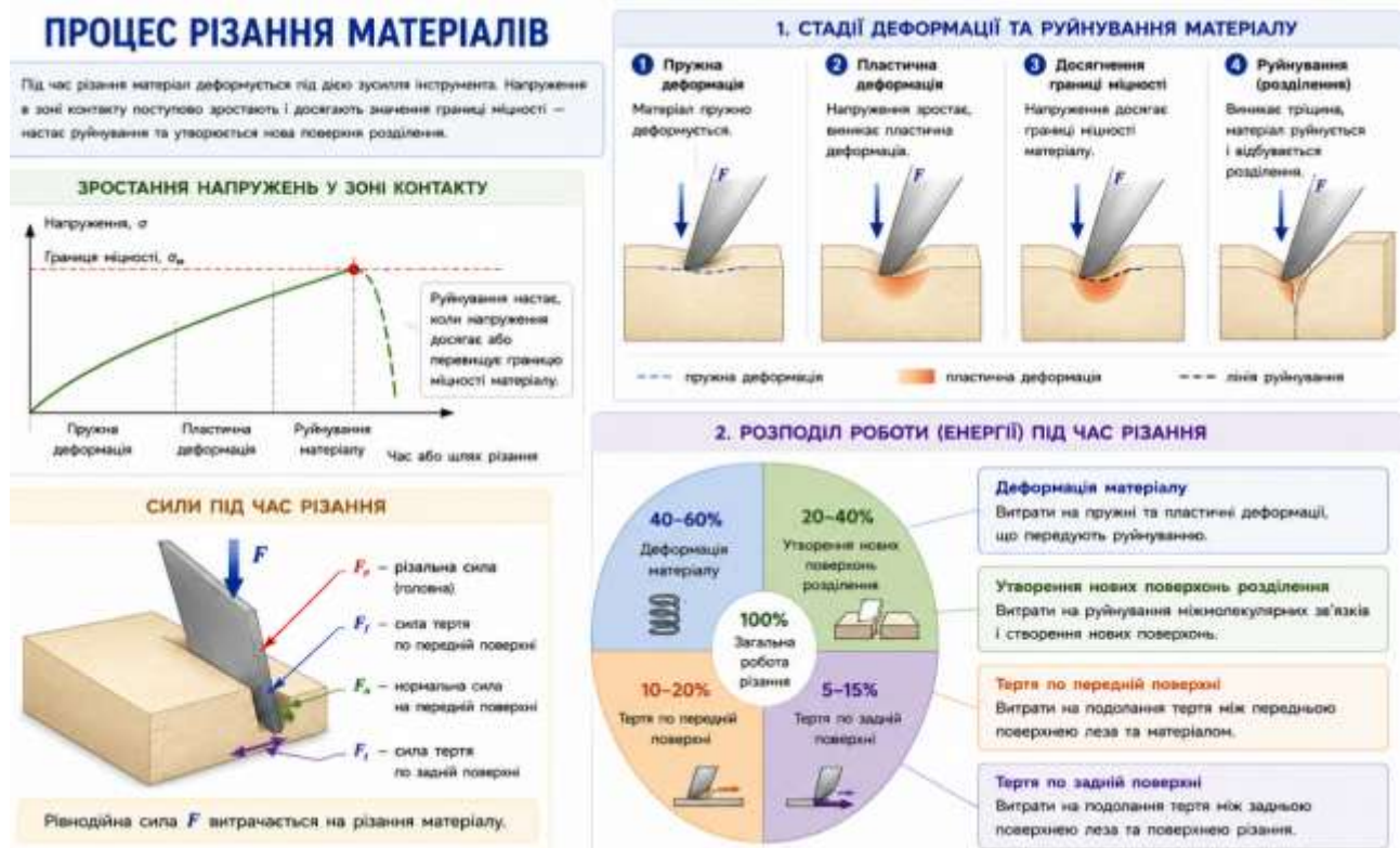
Рис. 9.35. Схема процесу різання матеріалів та розподіл роботи, що витрачається на різання
