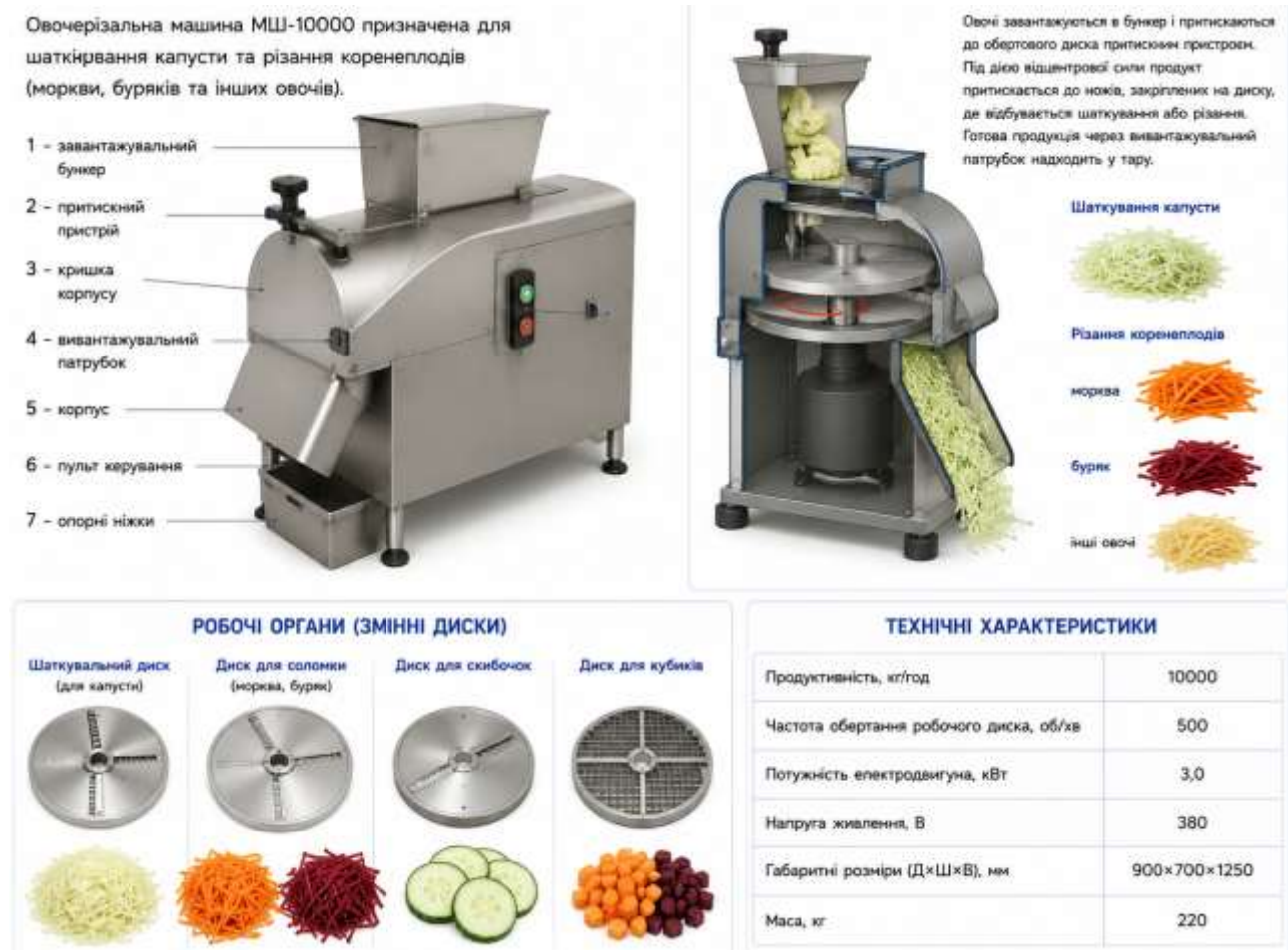
Рис. 9.38. Овочерізальна машина МШ-10000: конструкція, робочі органи та принцип роботи
