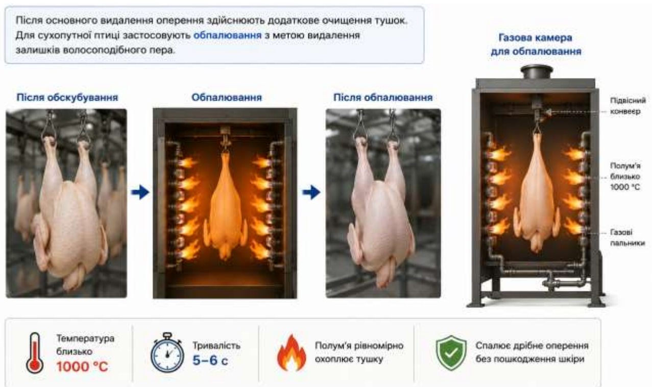
Рис. 8.8. Обпалювання тушок птиці для видалення залишків волосоподібного пера
