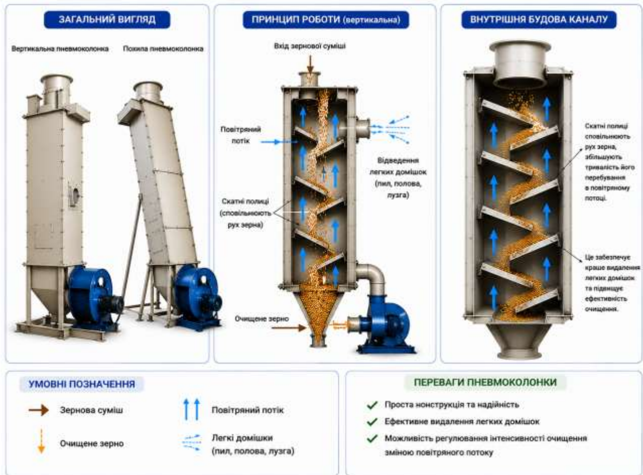
Рис. 7.7. Будова та принцип роботи пневмоколонки (аспіраційного каналу)
