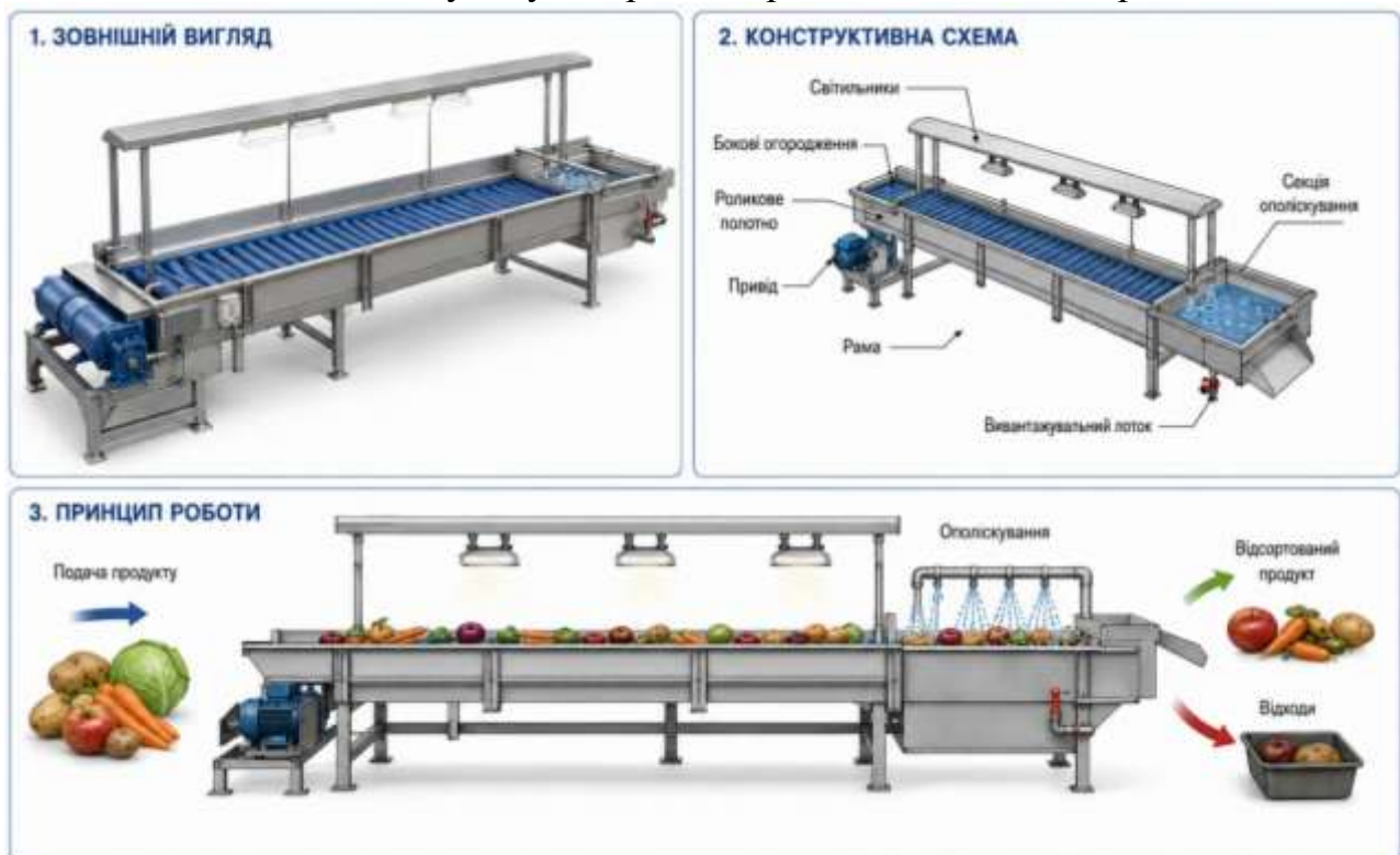
Рис. 7.39. Загальний вигляд, будова та принцип роботи інспекційного роликового конвеєра А9-КТ2-0
