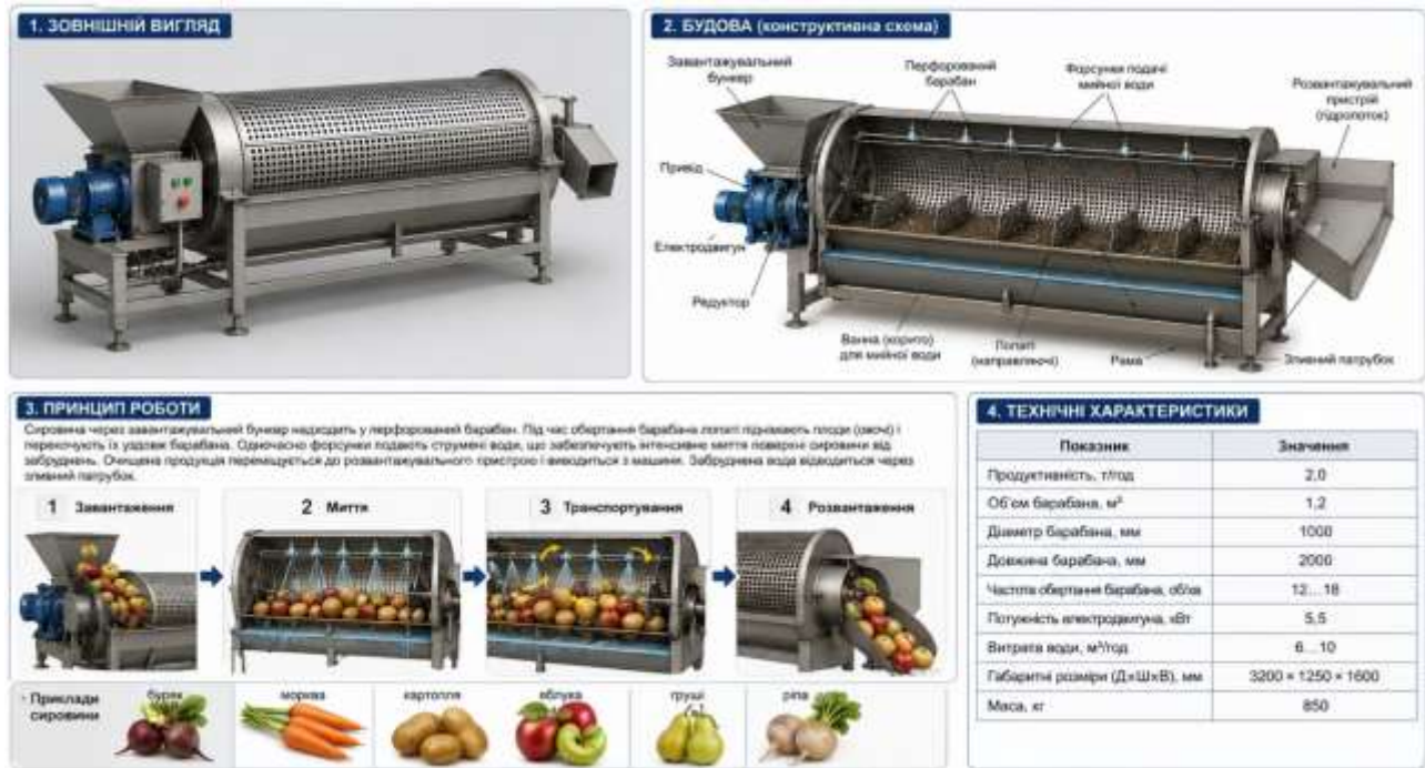
Рис. 5.6. Барабанна мийна машина А9-КМ-2: зовнішній вигляд, будова та принцип роботи
