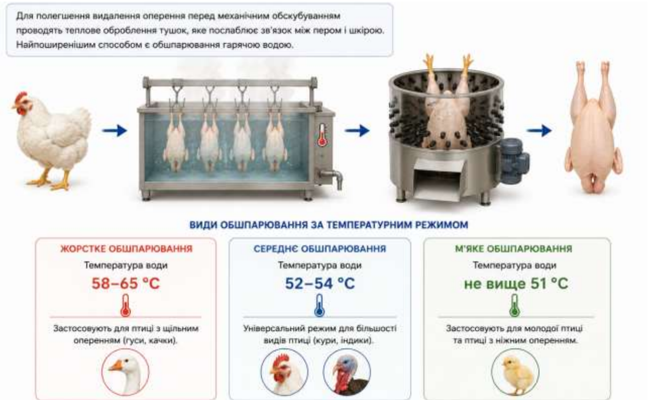
Рис. 8.7. Режими обшпарювання тушок птиці перед механічним видаленням оперення
