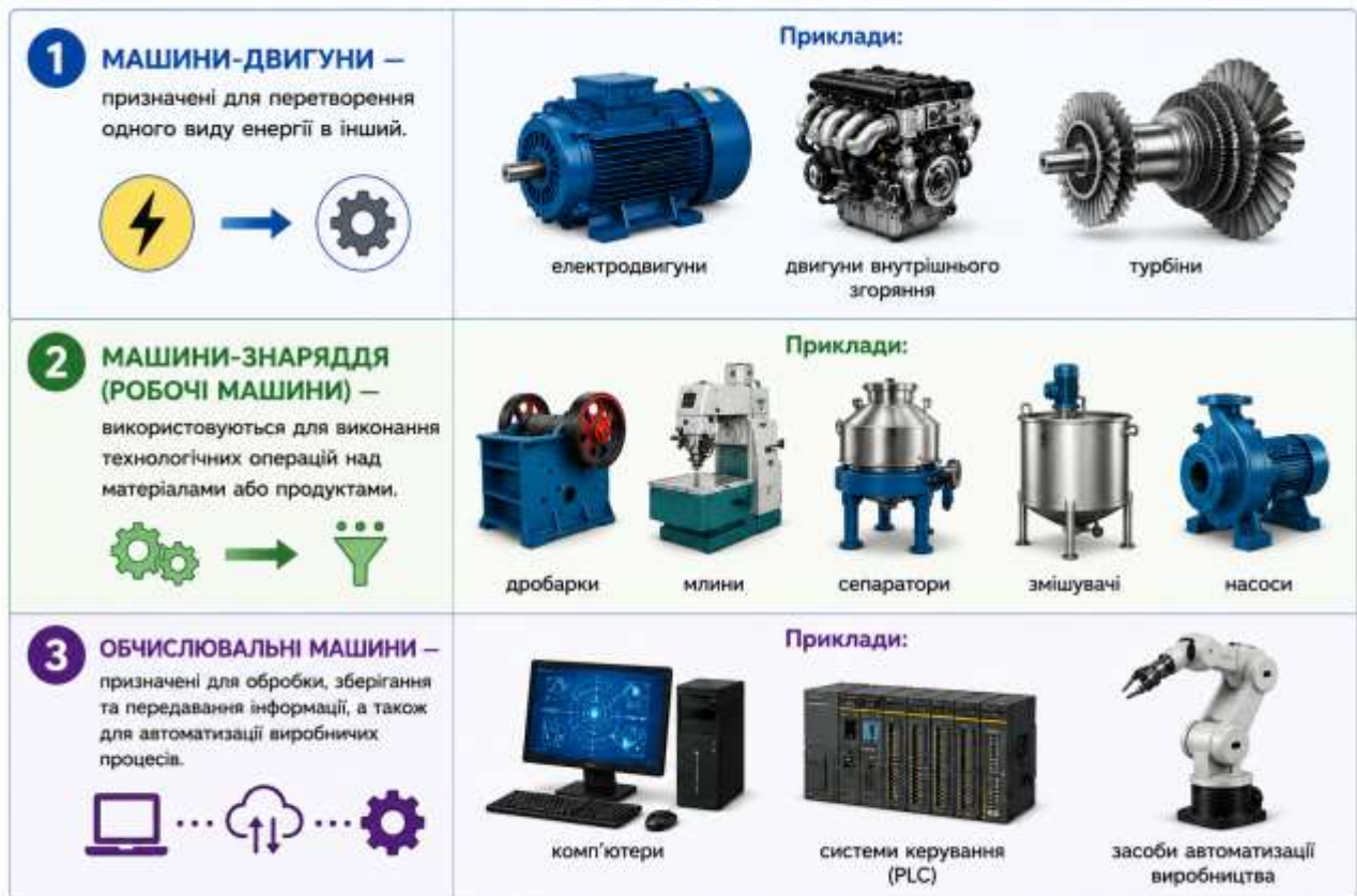
Рис. 2.1 Класифікація машин за призначенням
