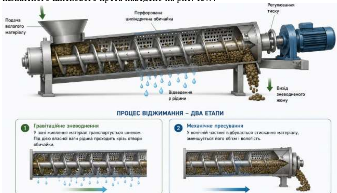
Рис. 13.9. Нахилений шнековий прес та принцип його роботи
