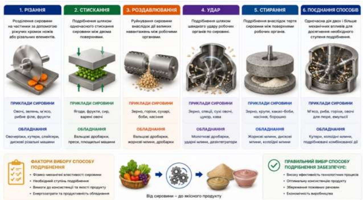
Рис. 9.4. Основні способи механічного подрібнення харчової сировини
