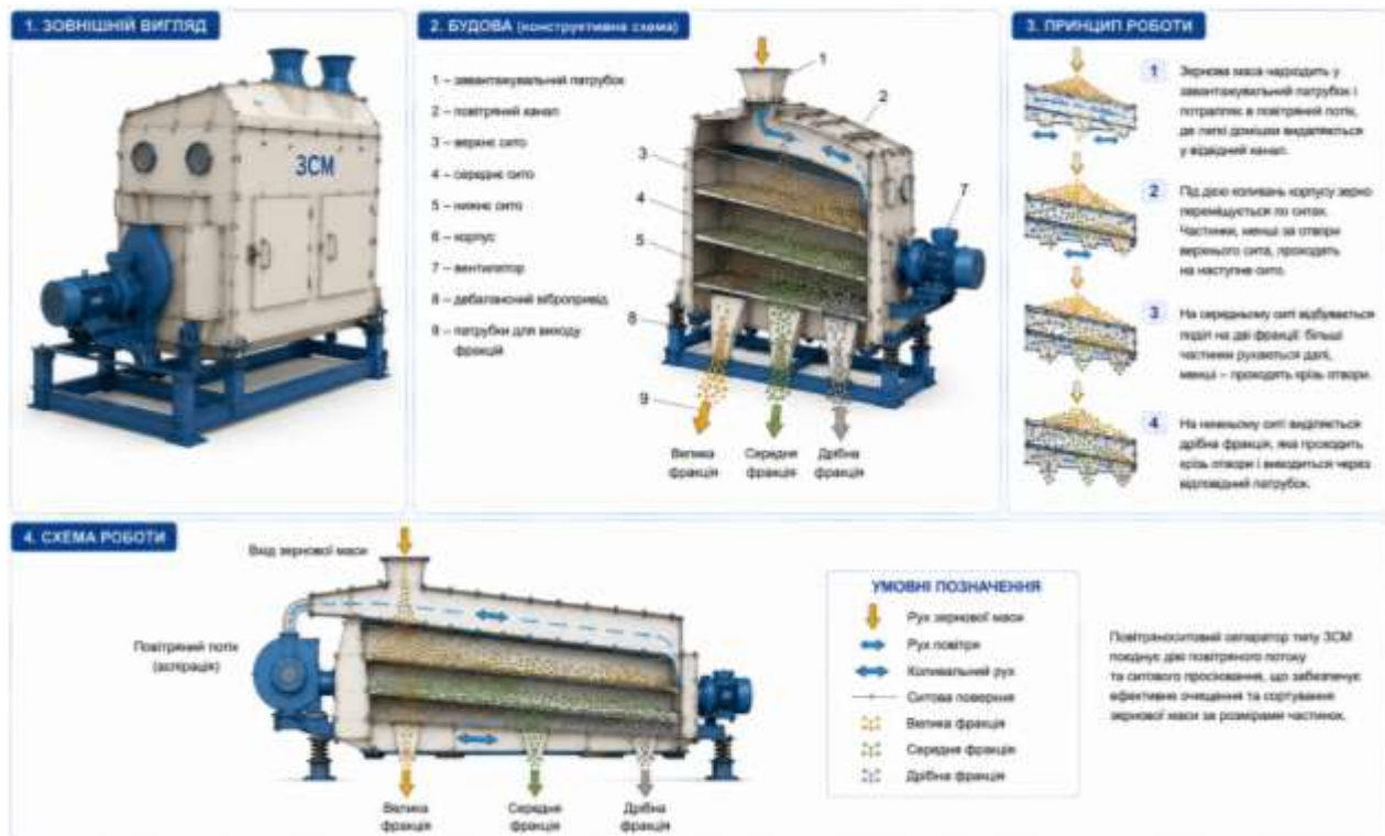
Рис. 7.24. Повітряноситовий сепаратор типу ЗСМ: зовнішній вигляд, будова та принцип роботи
