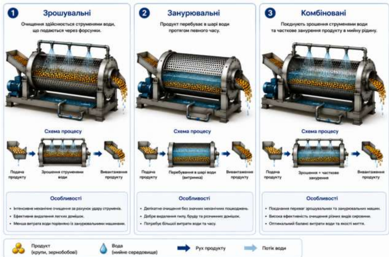
Рис. 6.3. Класифікація барабанних мийних машин за способом подачі мийного середовища
