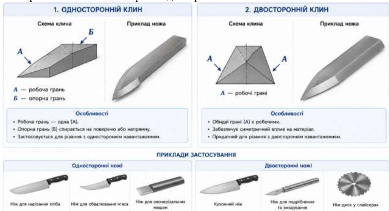
Рис. 9.27. Конструктивні особливості односторонніх і двосторонніх ріжучих клинів
