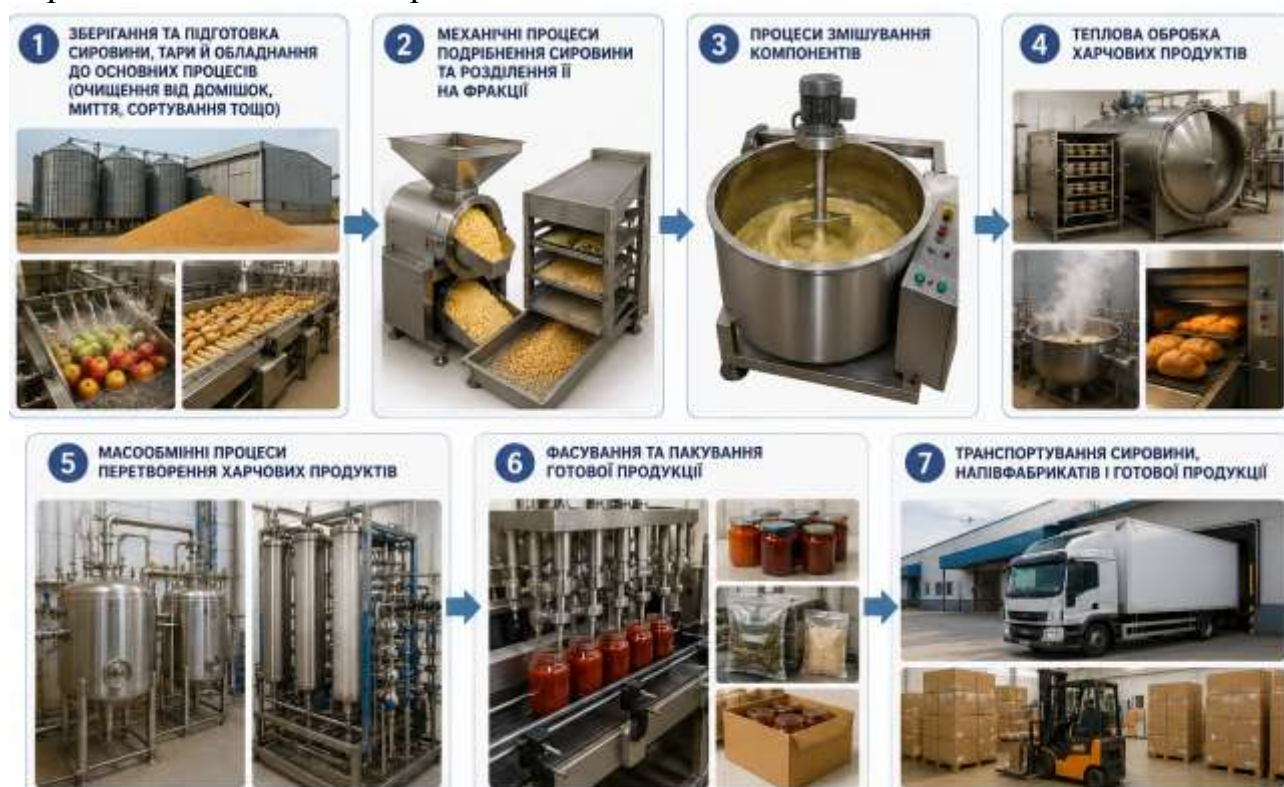
Рис 1.1. Етапи технологічного процесу в харчових виробництвах
