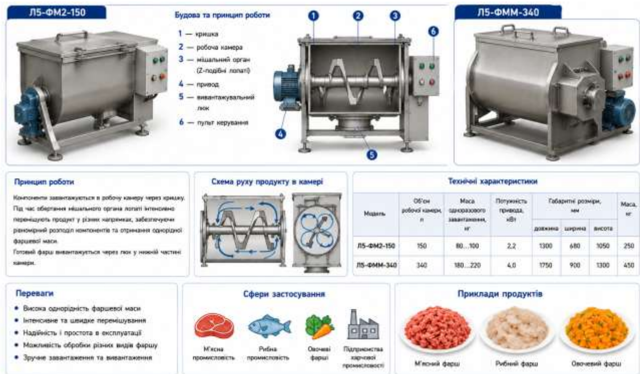
Рис. 10.31. Зовнішній вигляд, будова та принцип роботи фаршмішалок Л5-ФМ2-150 і Л5-ФММ-340
