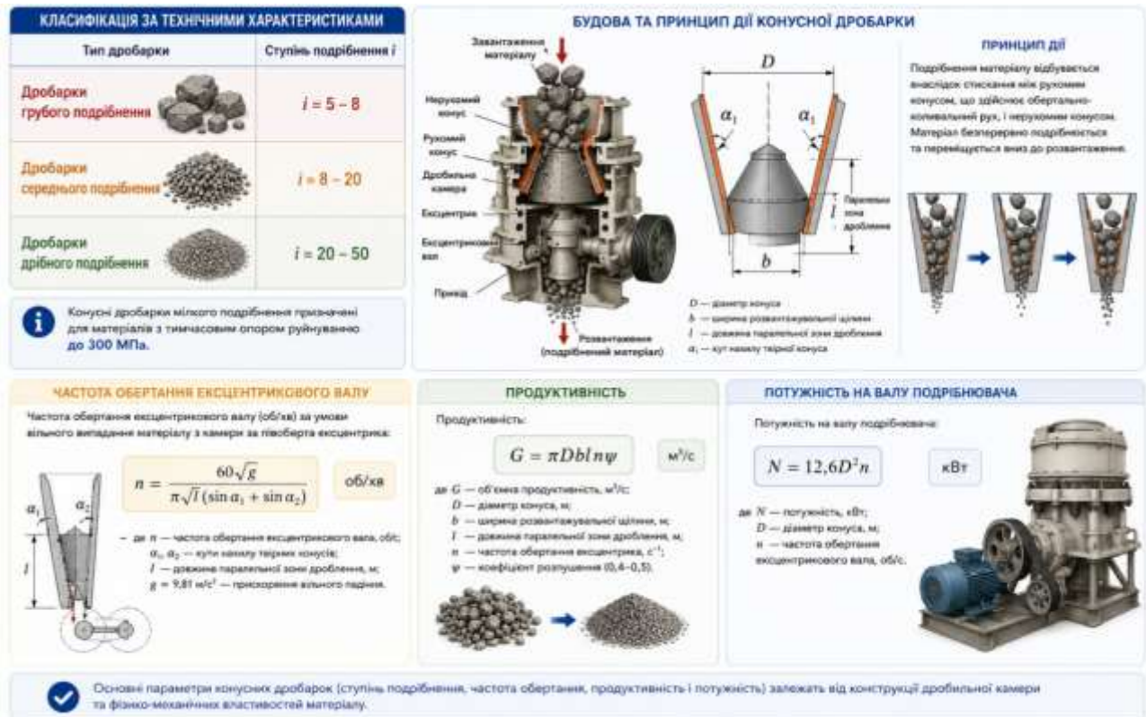
Рис. 9.16. Конусні дробарки: класифікація, принцип дії та основні розрахункові параметри
