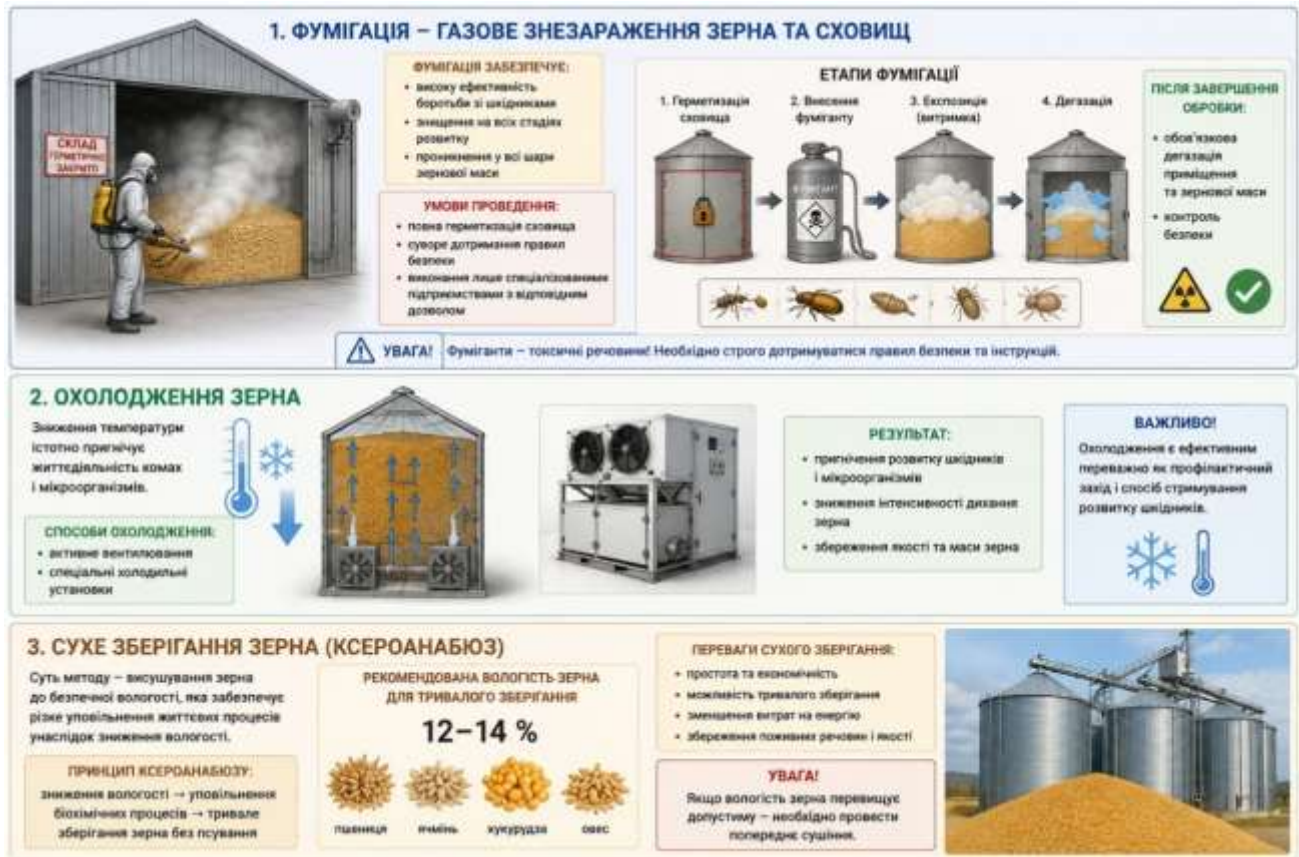
Рис. 4.3. Технологічні методи боротьби зі шкідниками та забезпечення тривалого зберігання зерна
