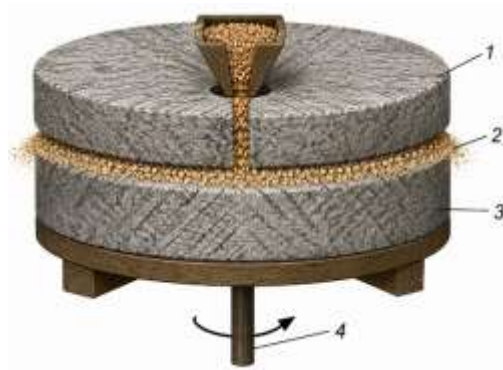
Рис. 9.5. Подрібнення стиранням за допомогою жорен:
