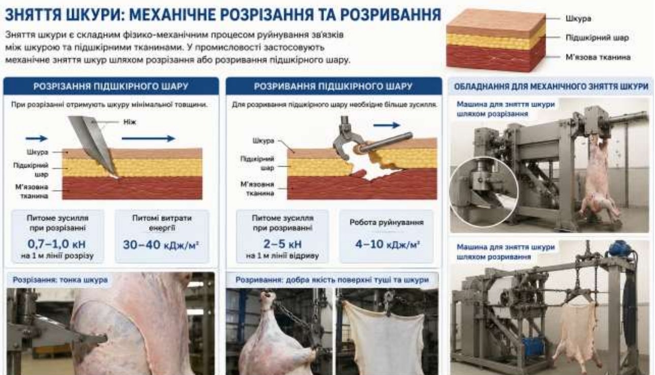
Рис. 8.1. Схема процесу механічного зняття шкури та обладнання для його виконання
