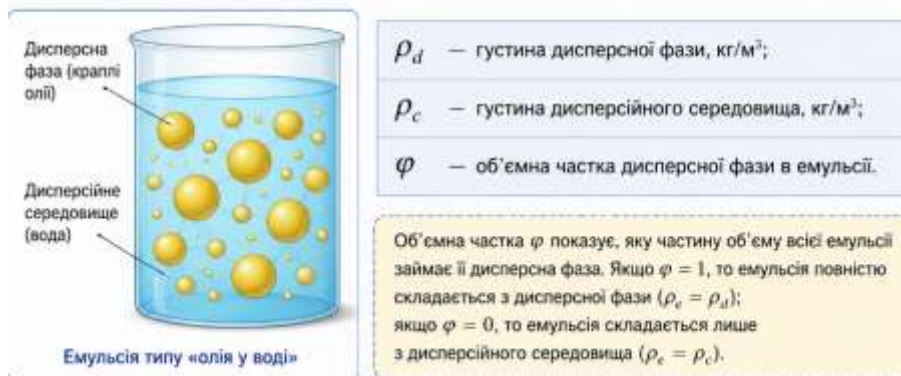
Рис. 1.11. Визначення густини емульсії
