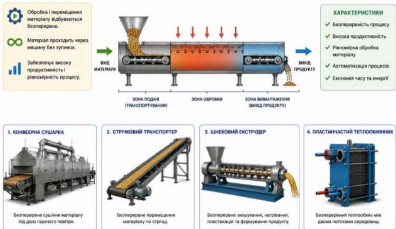
Рис. 2.11. Принципова схема роботи безперервно-потоківих машин та приклади обладнання безперервної дії
