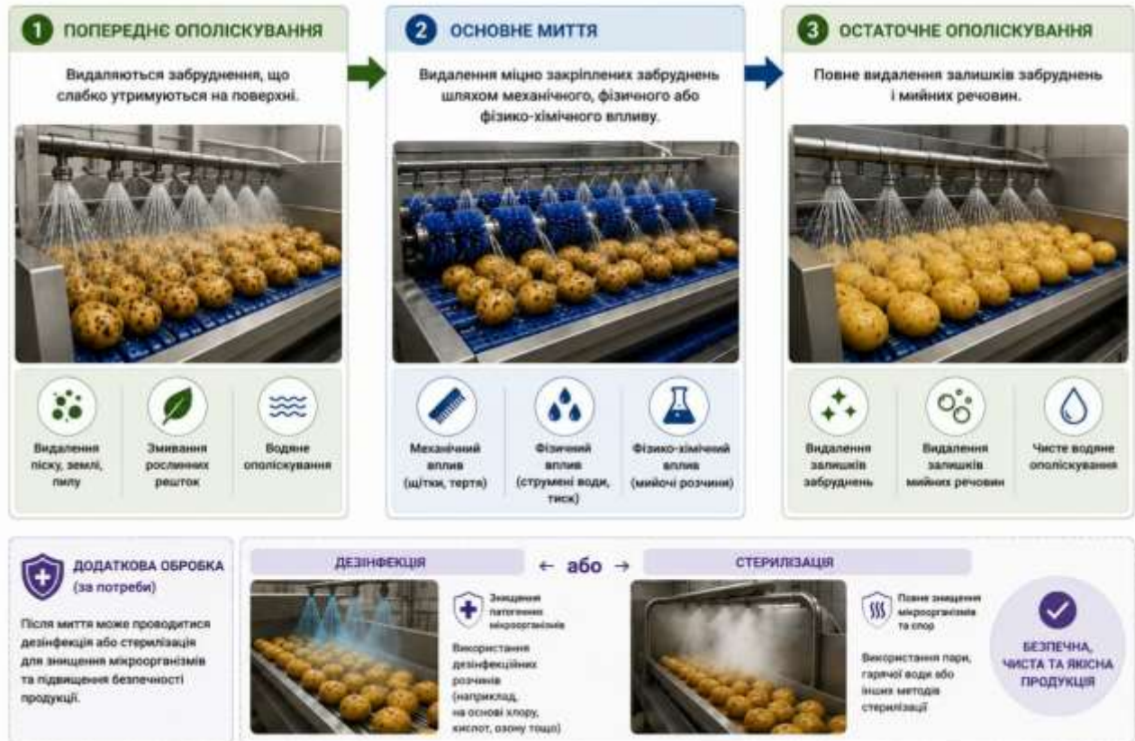
Рис. 5.1. Технологічний процес миття сільськогосподарської сировини
