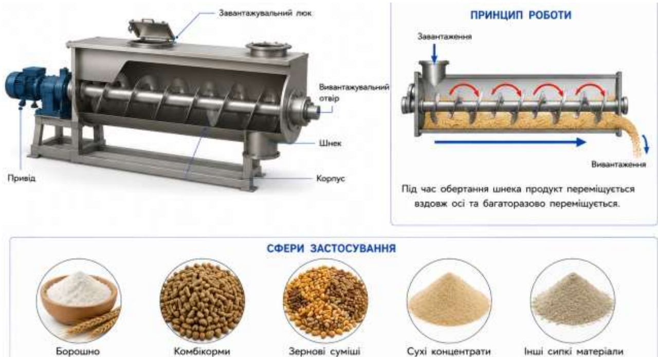
Рис. 10.21. Шнековий змішувач для сипких матеріалів
