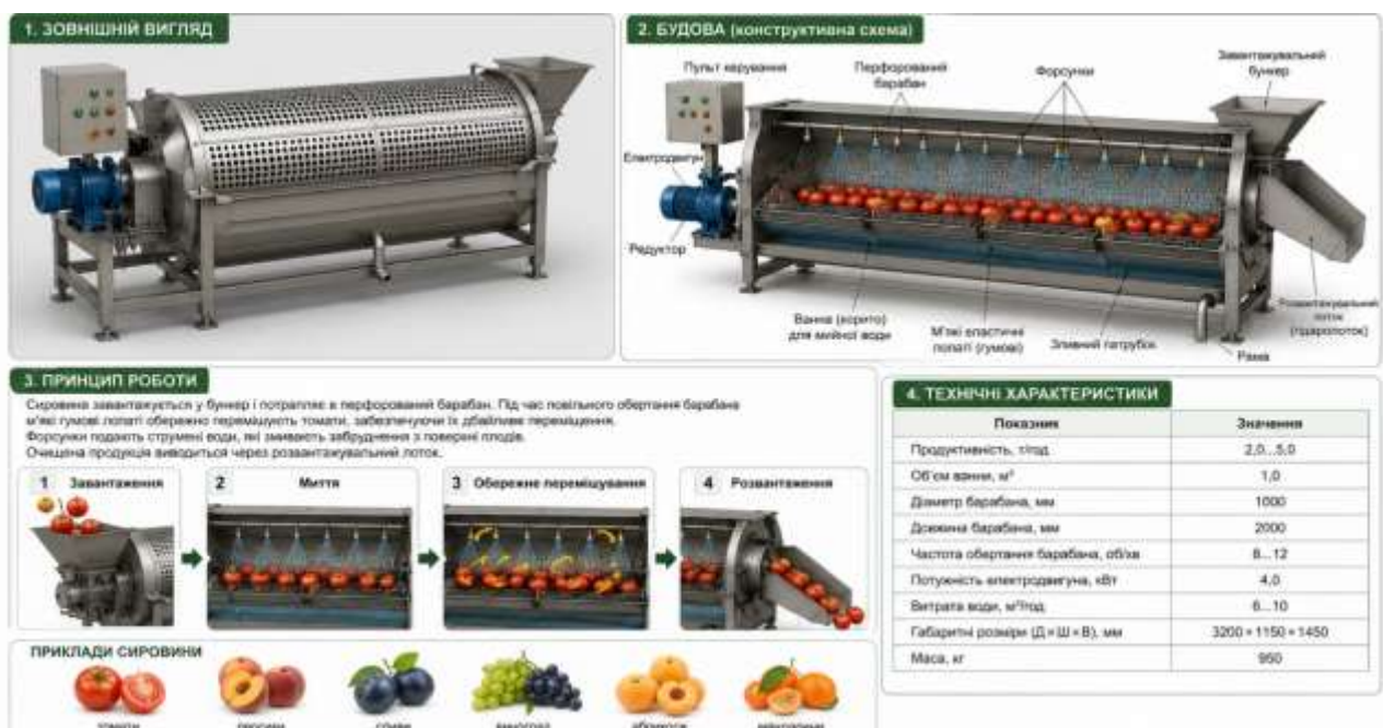
Рис. 5.8. Мийна машина типу А9-КМБ: зовнішній вигляд, будова та принцип роботи
