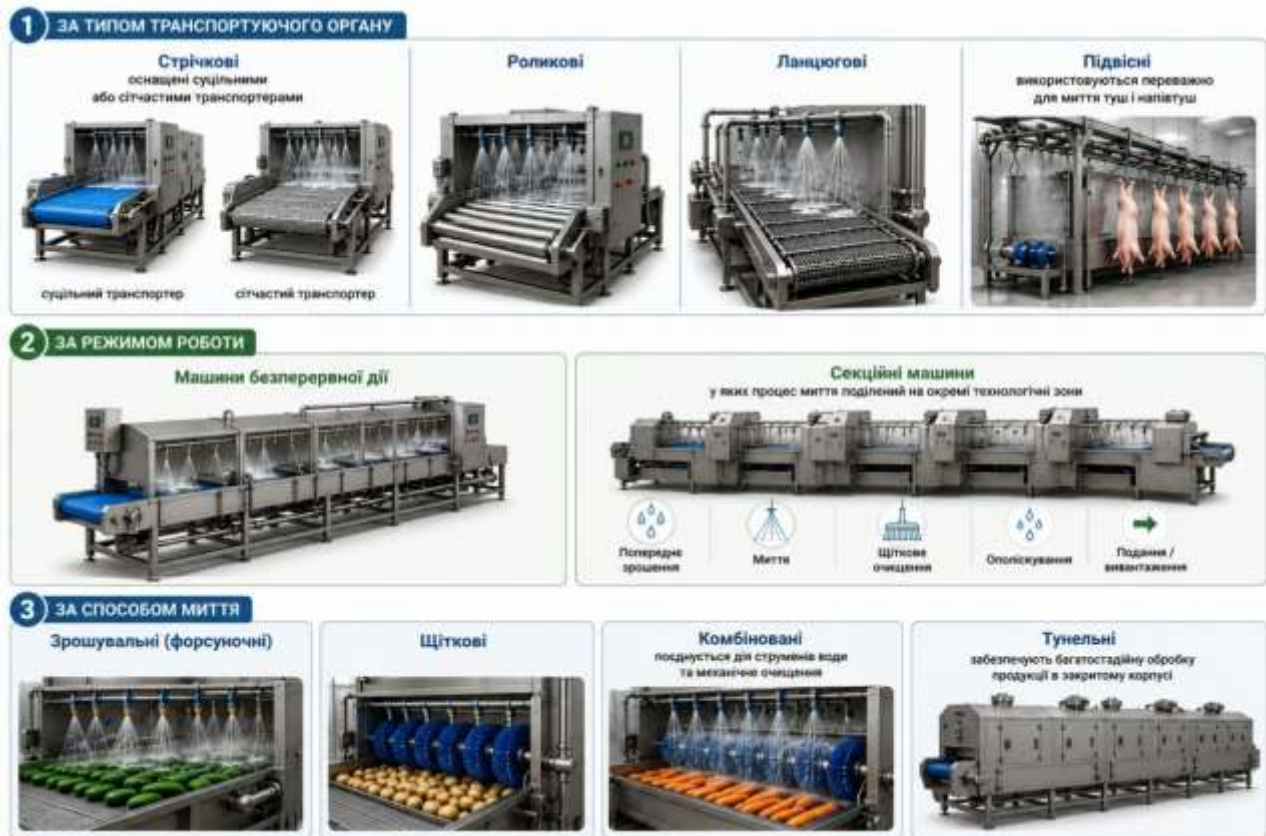
Рис. 6.9. Класифікація конвеєрних мийних машин за конструкцією, режимом роботи та способом миття
