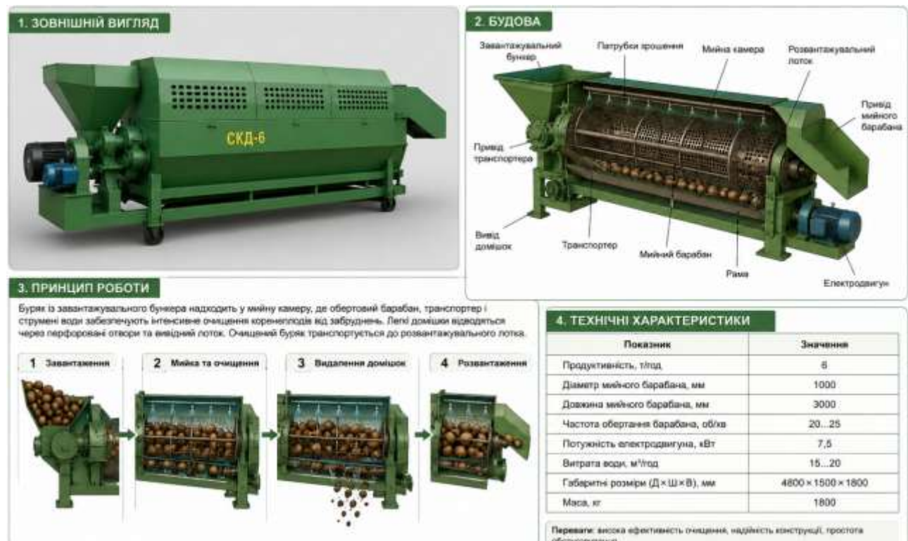
Рис. 5.3. Бурякомийна машина СКД-6: а — зовнішній вигляд; б — будова; в — принцип роботи
