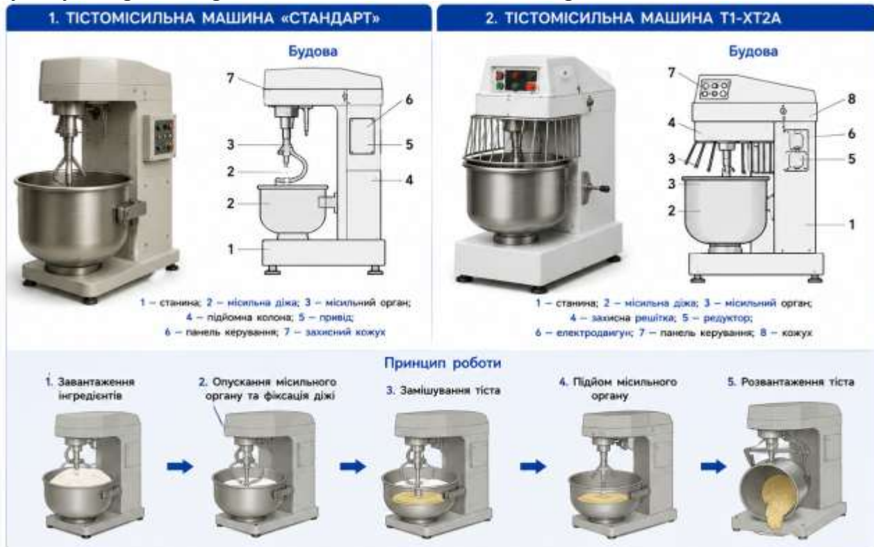
Рис. 10.27. Зовнішній вигляд, будова та принцип роботи тістомісильних машин «Стандарт» і Т1-ХТ2А
