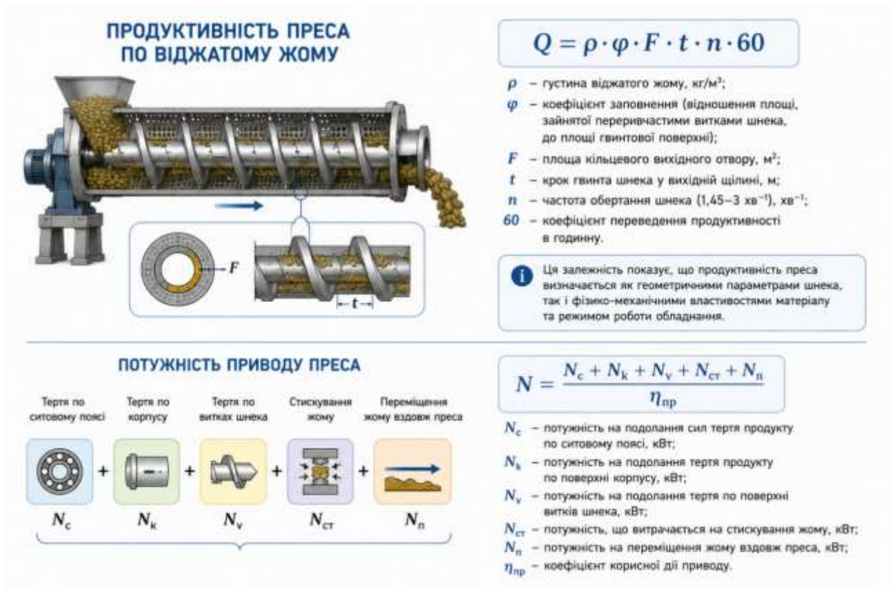
Рис. 13.12. Продуктивність і потужність приводу шнекового преса
