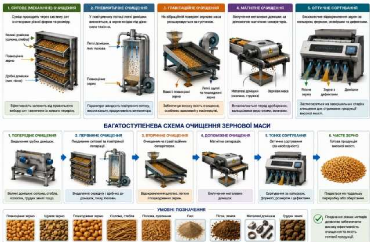
Рис. 7.1. Основні способи очищення зернової маси та багатоступенева схема її обробки
