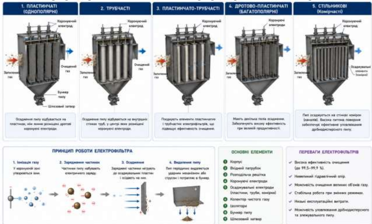
Рис. 11.11. Основні типи електрофільтрів та принцип їх роботи
