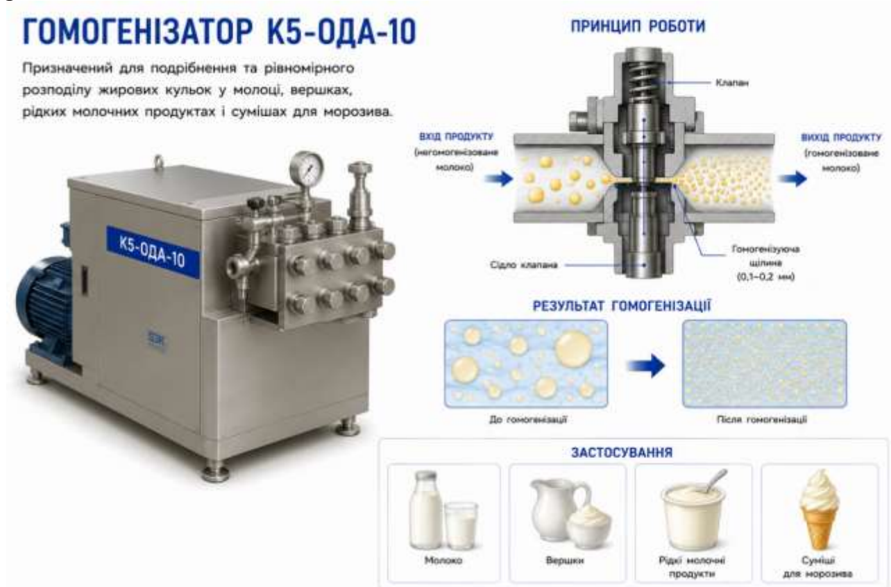
Рис. 9.41. Гомогенізатор К5-ОДА-10: конструкція, принцип роботи та результати гомогенізації
