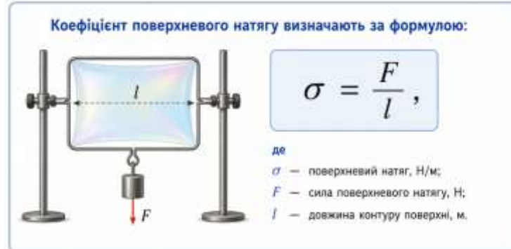
Рис. 1.23. Схема визначення поверхневого натягу
