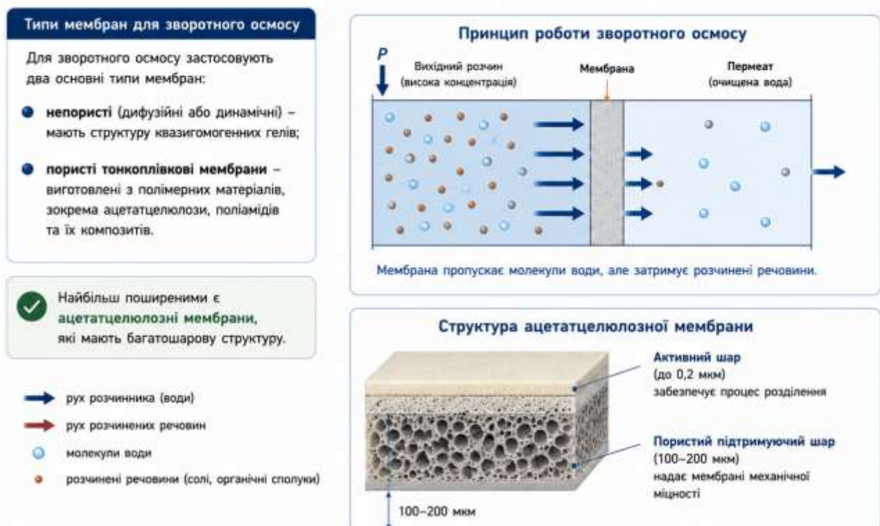
Рис. 12.6. Типи мембран для зворотного осмосу і структура ацетатцелюлозної мембрани
