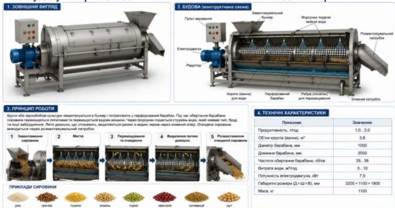
Рис. 5.10. Мийна машина А1-БМГ: зовнішній вигляд, будова та принцип роботи
