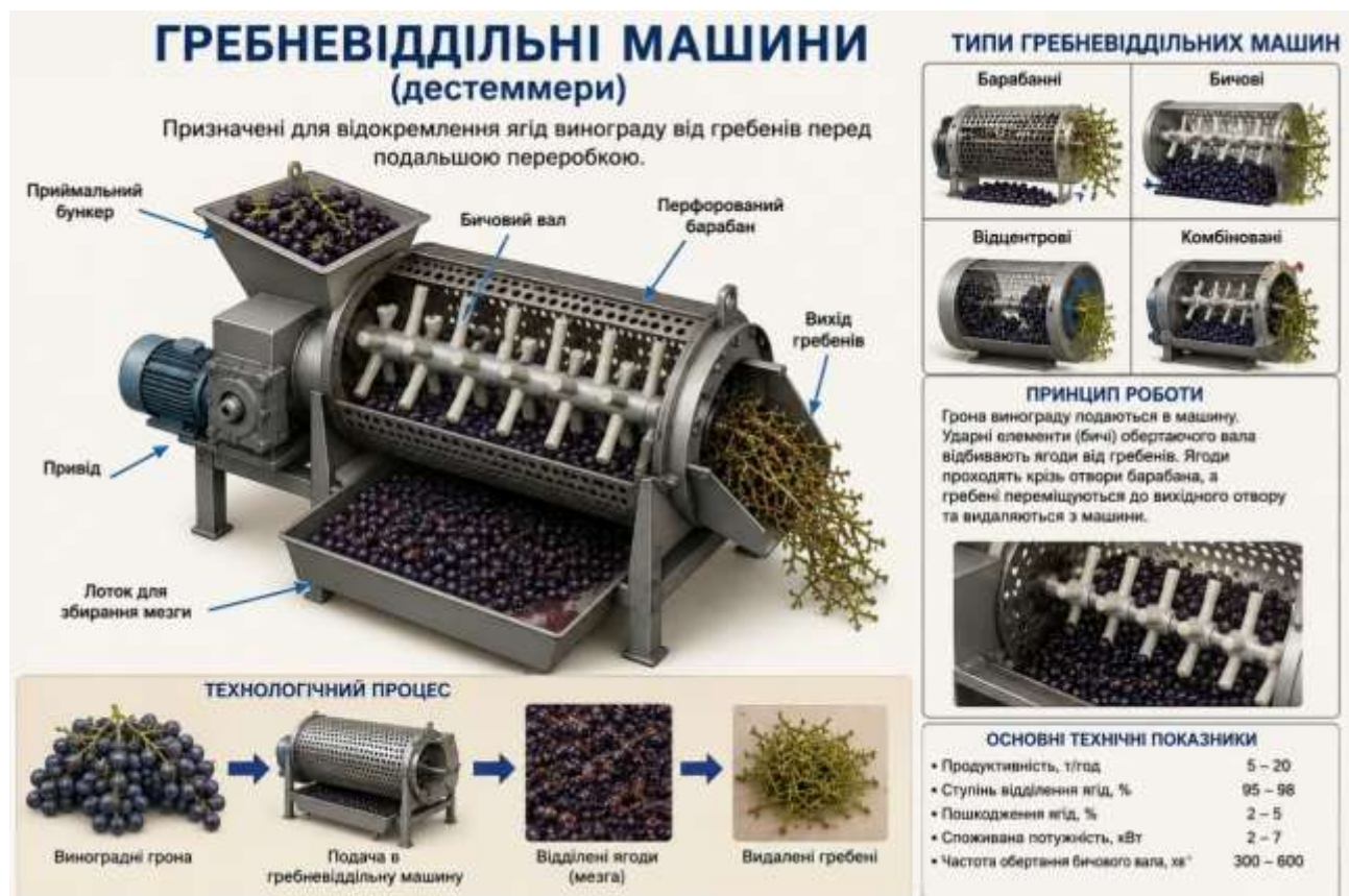
Рис. 7.36. Будова, типи та принцип роботи гребневіддільних машин
