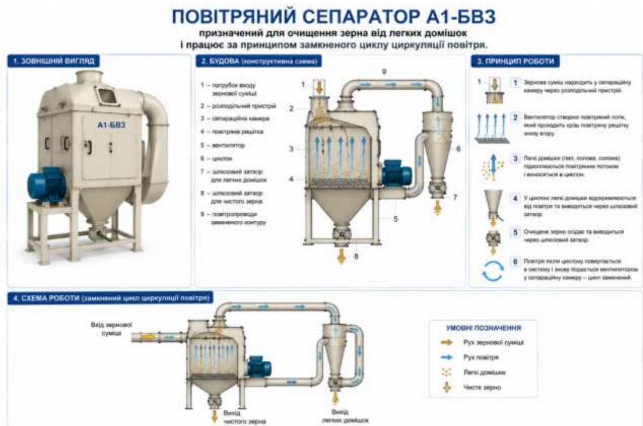
Рис. 7.10. Повітряний сепаратор А1-БВЗ: зовнішній вигляд, будова та принцип роботи
