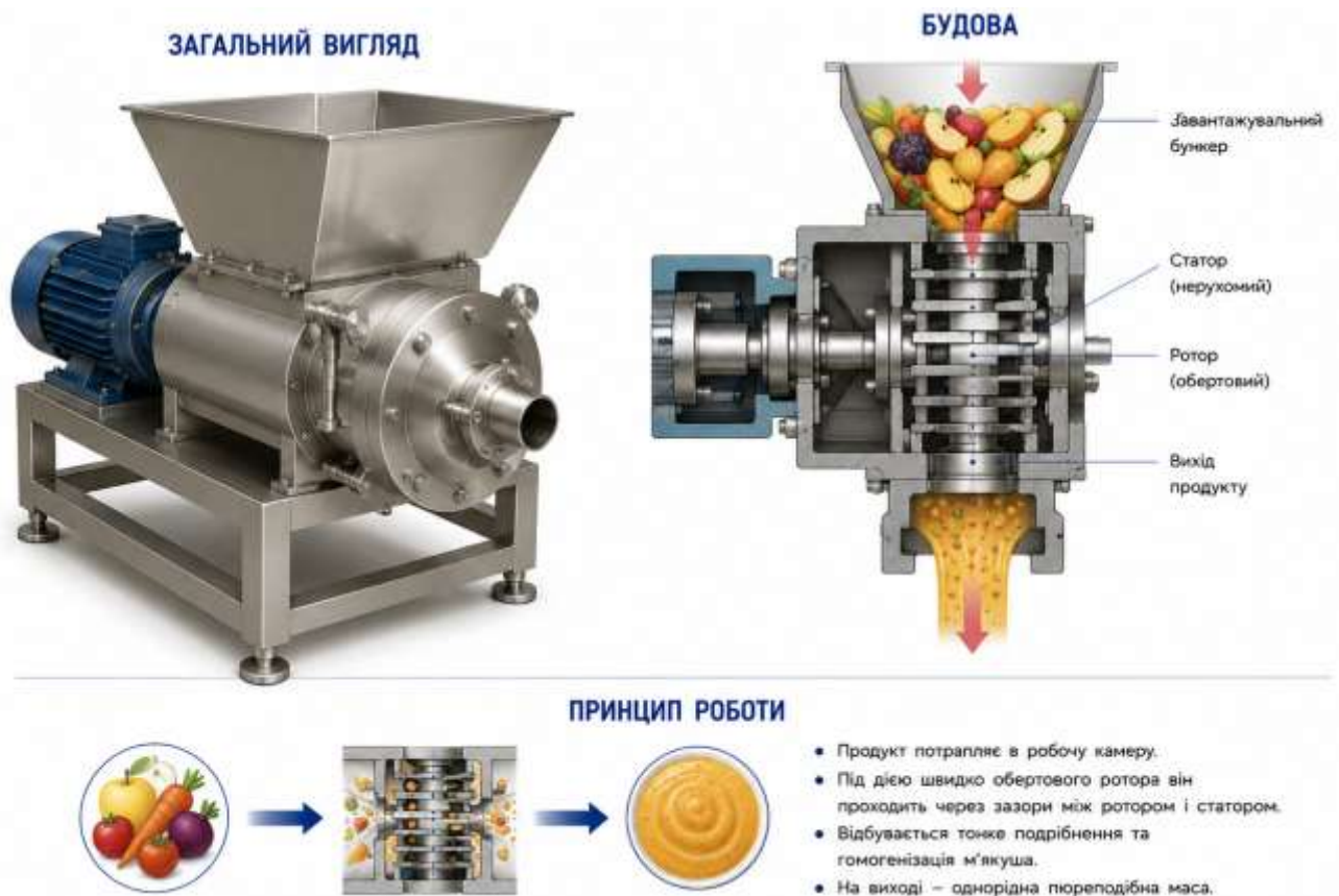
Рис. 9.43. Загальний вигляд, будова та принцип роботи гомогенізатора РЗ-КІК роторно-статорного типу
