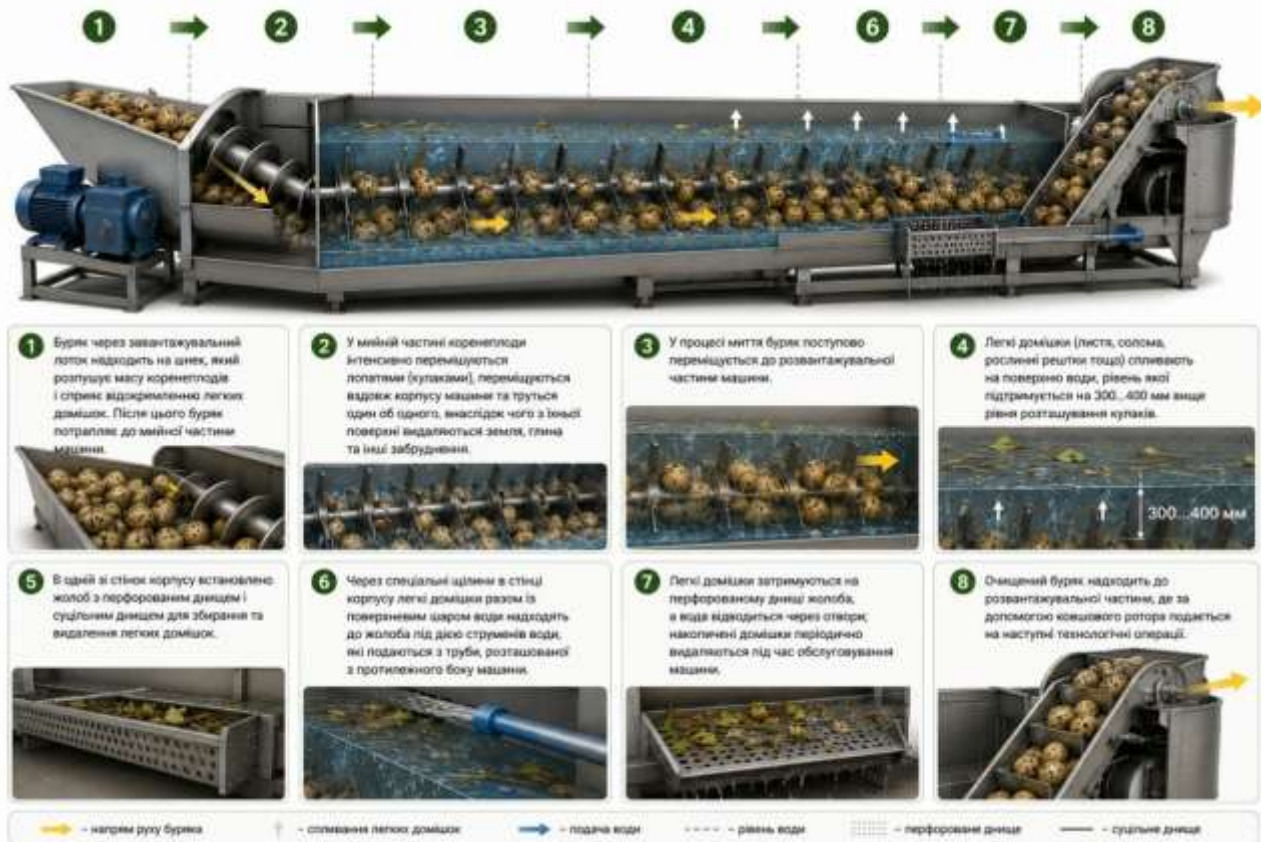
Рис. 5.2. Технологічний процес роботи однокорпусної бурякомийної машини
