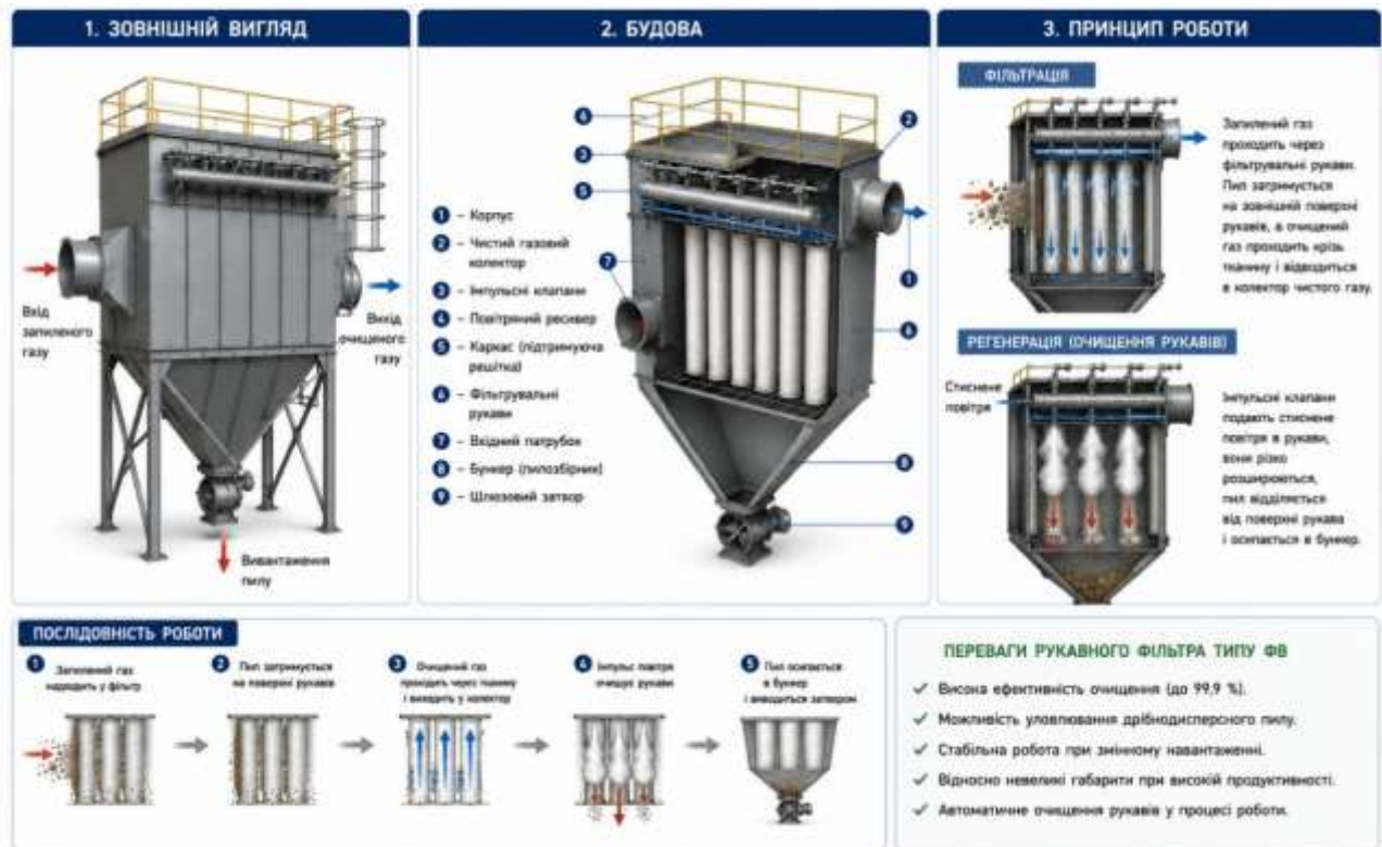
Рис. 11.10. Конструкція та схема роботи рукавного фільтра типу ФВ
