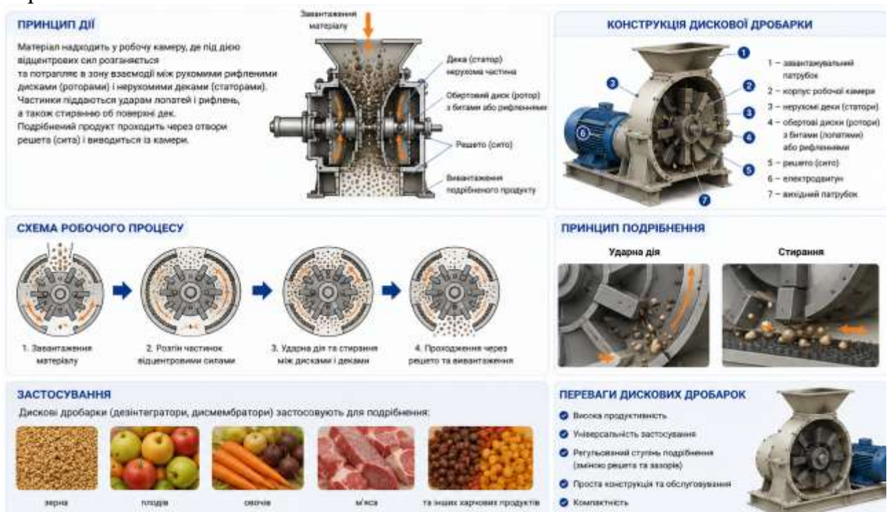
Рис. 9.20. Дискові дробарки (дезінтегратори, дисмембратори): будова та принцип дії
