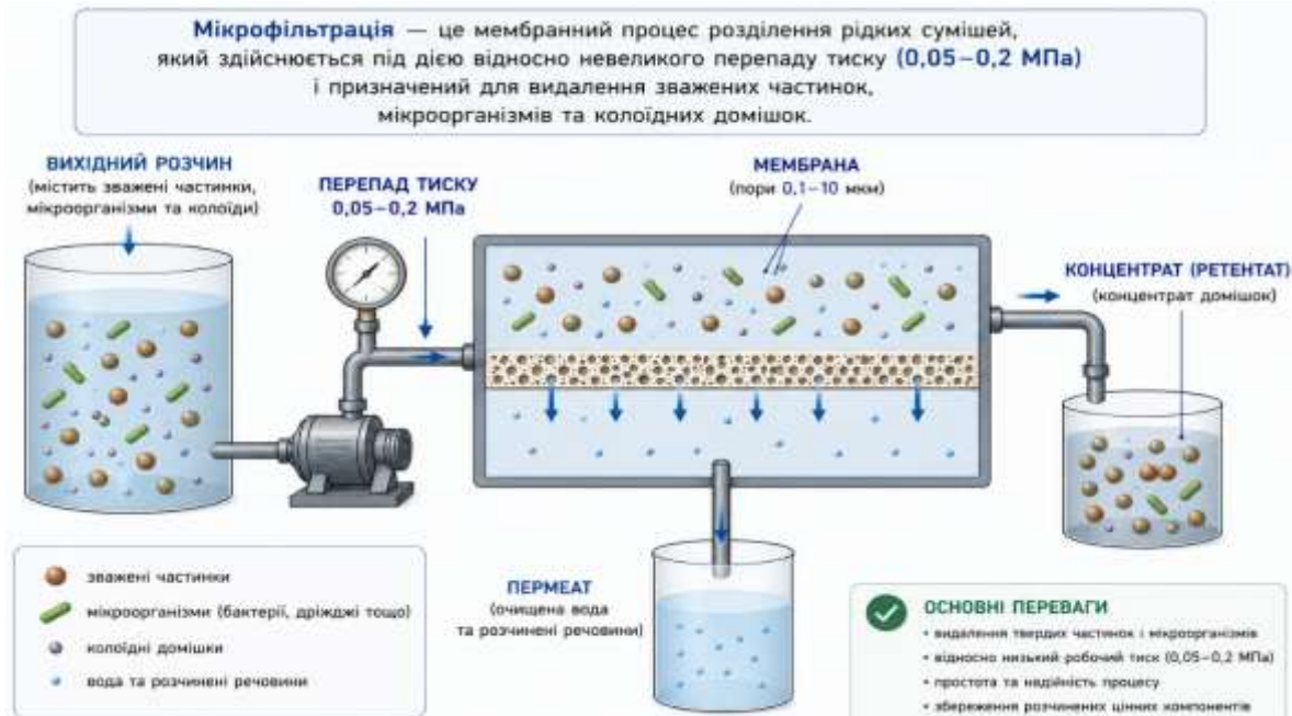
Рис. 12.8. Схема процесу мікрофільтрації
