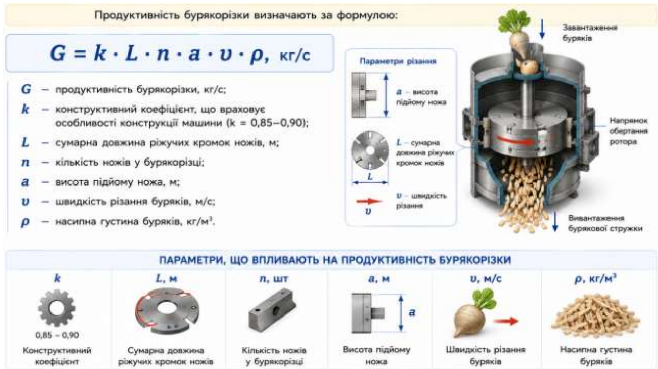
Рис. 9.32. Схема визначення продуктивності бурякорізки та параметри, що впливають на її роботу
