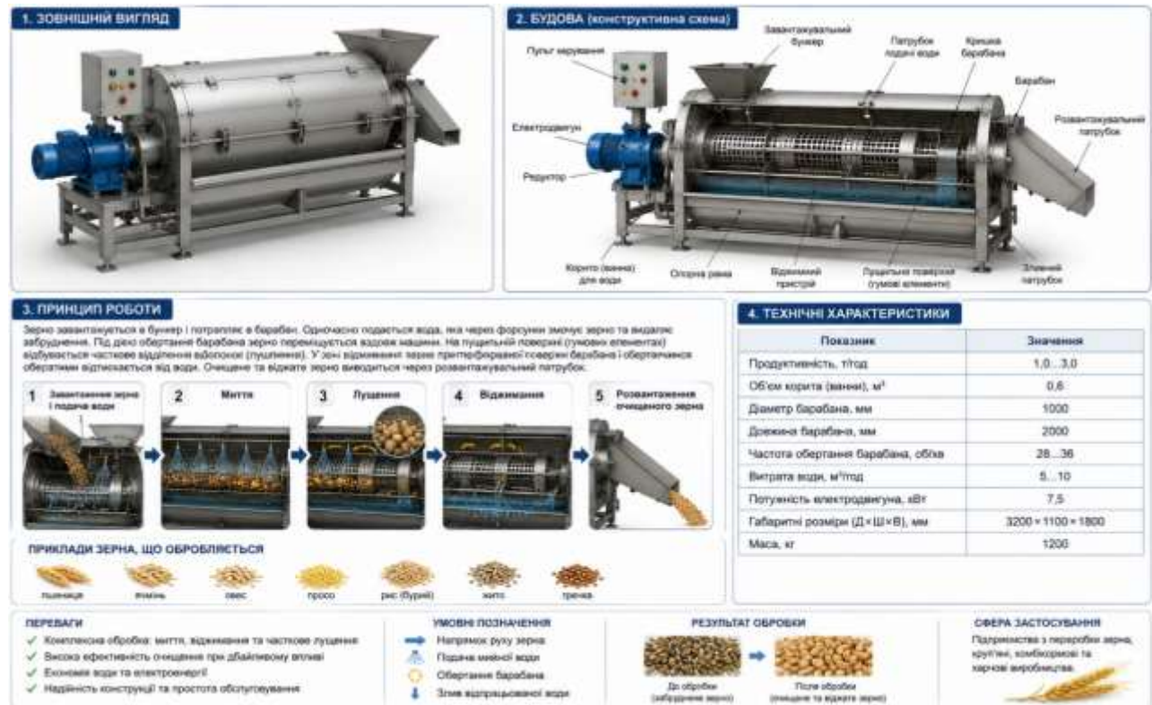
Рис. 5.9. Машина А1-БМШ: зовнішній вигляд, будова та принцип роботи
