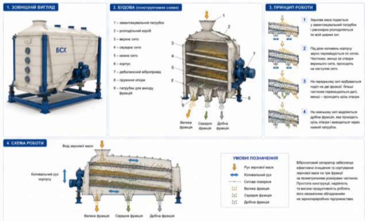
Рис. 7.23. Віброситовий сепаратор типу БСХ: зовнішній вигляд, будова та принцип роботи
