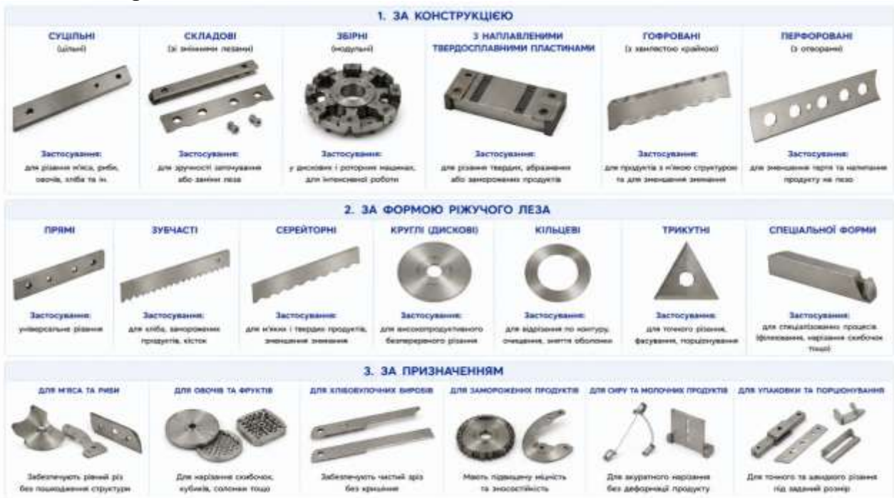
Рис. 9.36. Класифікація ножів для різальних машин за конструкцією, формою ріжучого леза та призначенням
