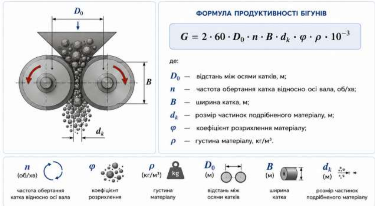
Рис. 9.23. Схема визначення продуктивності бігунів та основні параметри розрахунку
