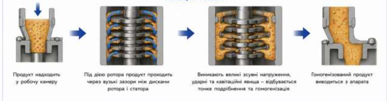
Рис. 9.44. Дисковий гомогенізатор БТ-2: загальний вигляд, основні вузли та принцип дії
