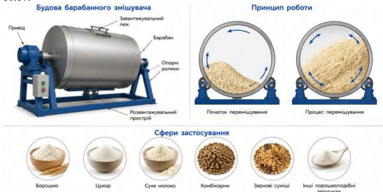
Рис. 10.17. Барабанний змішувач періодичної дії для перемішування сипких матеріалів
