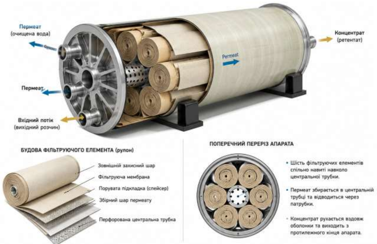
Рис. 12.10. Мембранний апарат рулонного типу з шістьма спільно навитими фільтруючими елементами
