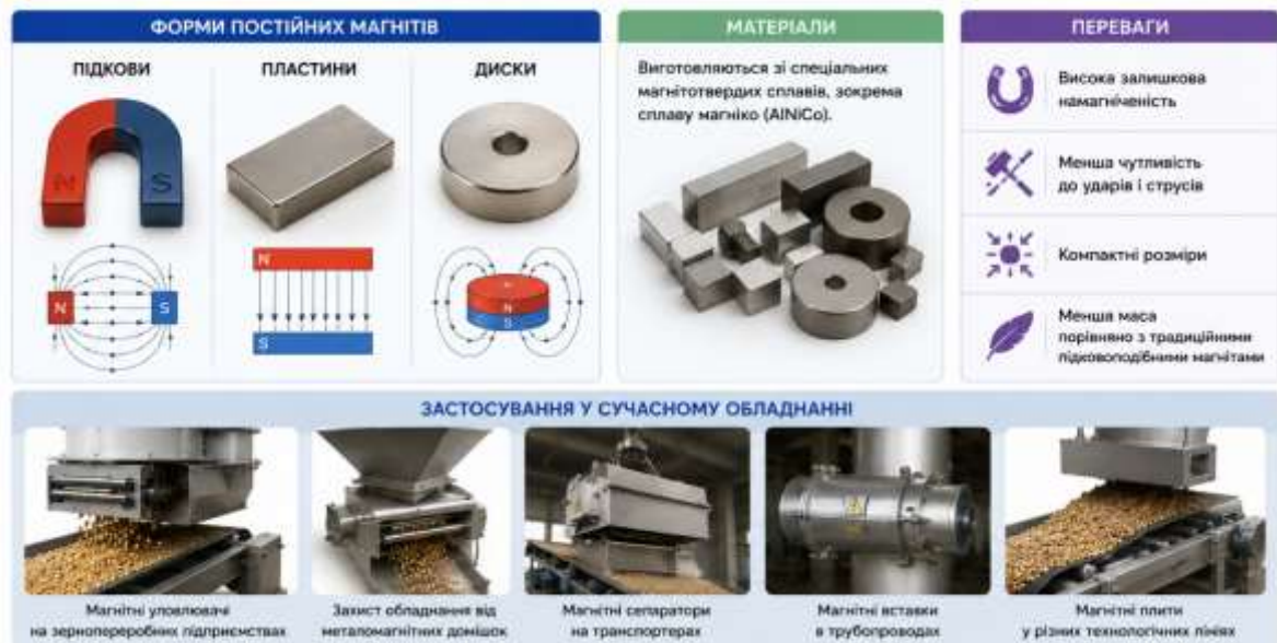
Рис. 7.33. Основні форми постійних магнітів і сфери їх використання
