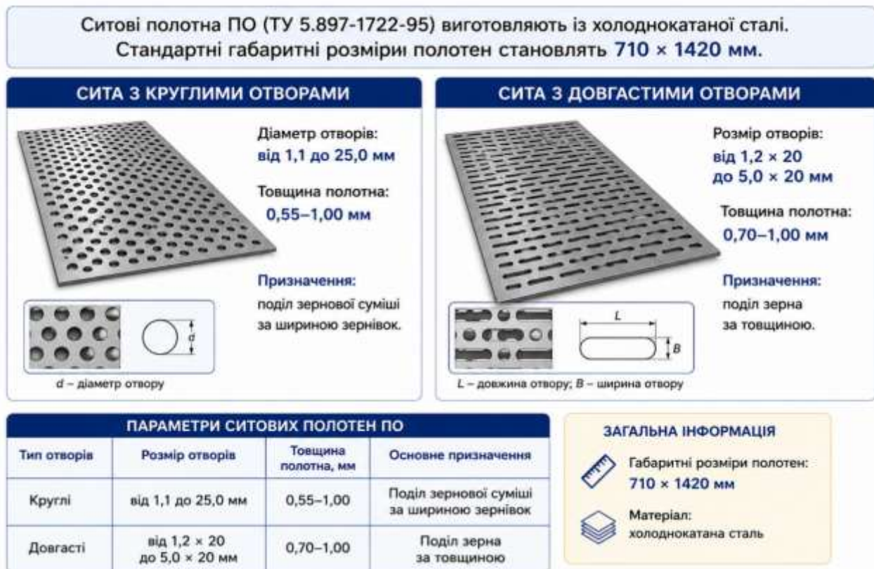
Рис. 7.16. Ситові полотна ПО з круглими та довгастими отворами для очищення і сортування зерна
