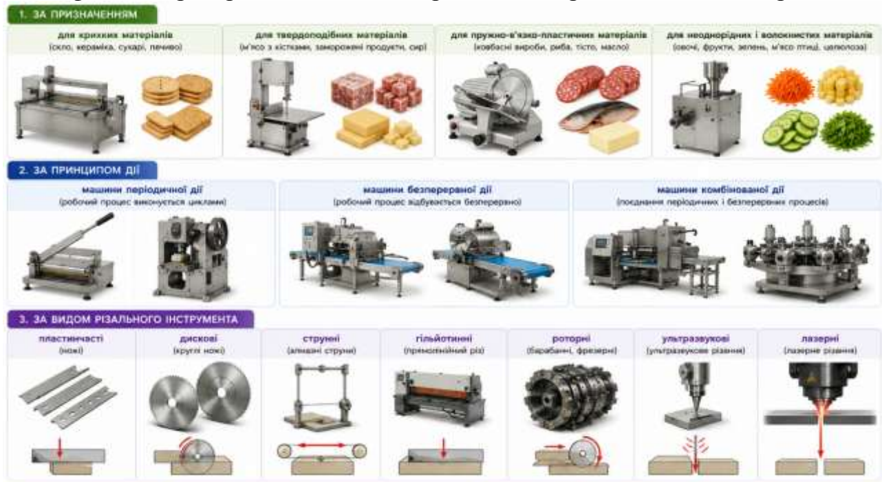
Рис. 9.33. Класифікація пристроїв та машин для різання матеріалів у харчовій та переробній промисловості
