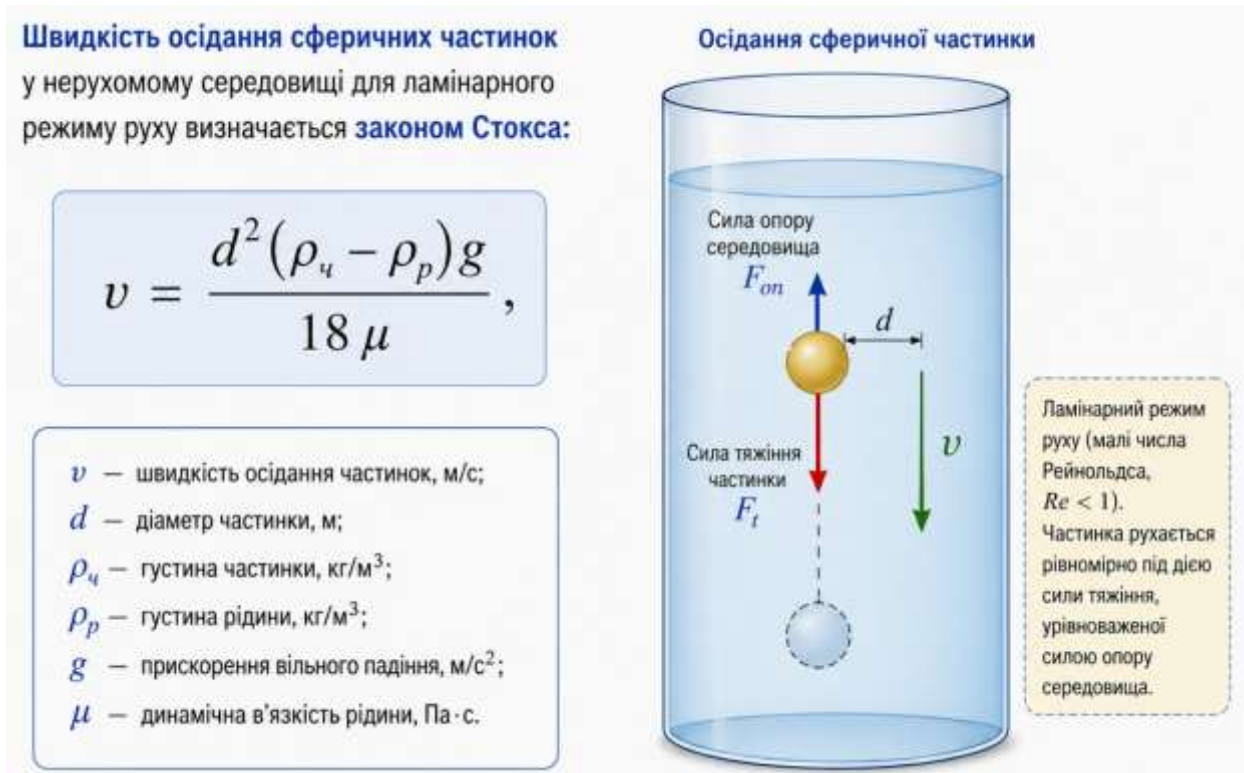
Рис. 1.5. Схema осадження сферичної частинки та закон Стокса
