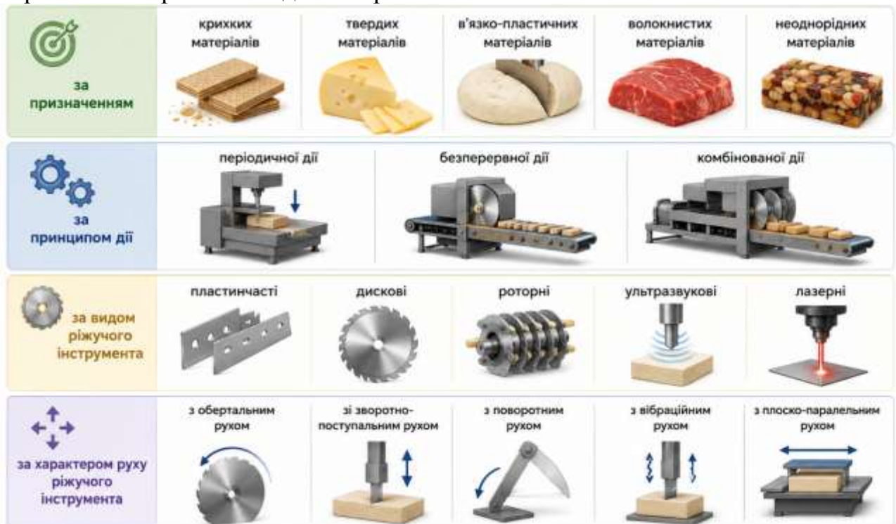
Рис. 9.25. Класифікація машин для різання харчових матеріалів за призначенням, принципом дії, видом ріжучого інструмента та характером його руху
