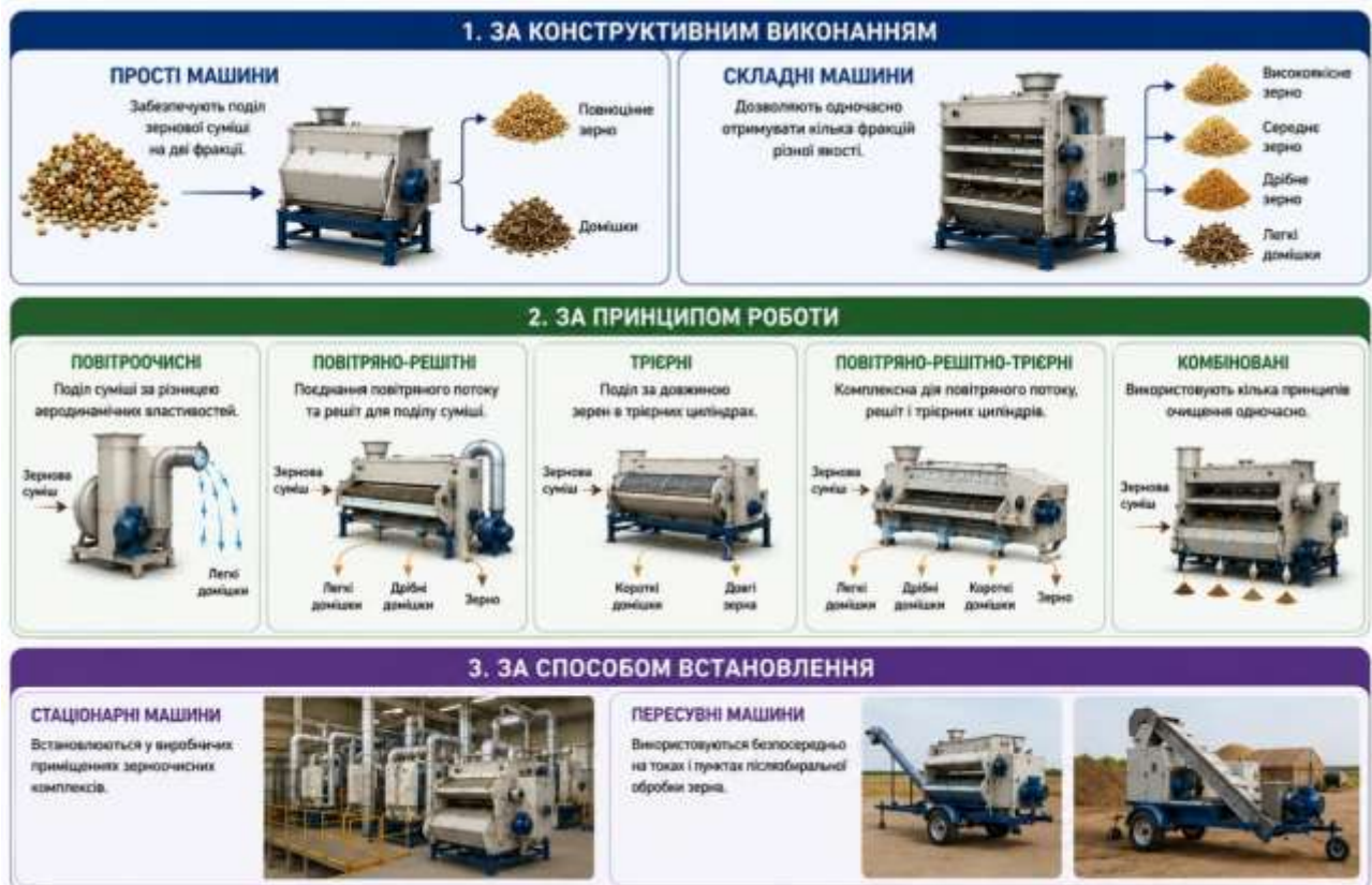
Рис. 7.3. Класифікація зерноочисних машин за конструктивним виконанням, принципом роботи та способом встановлення
