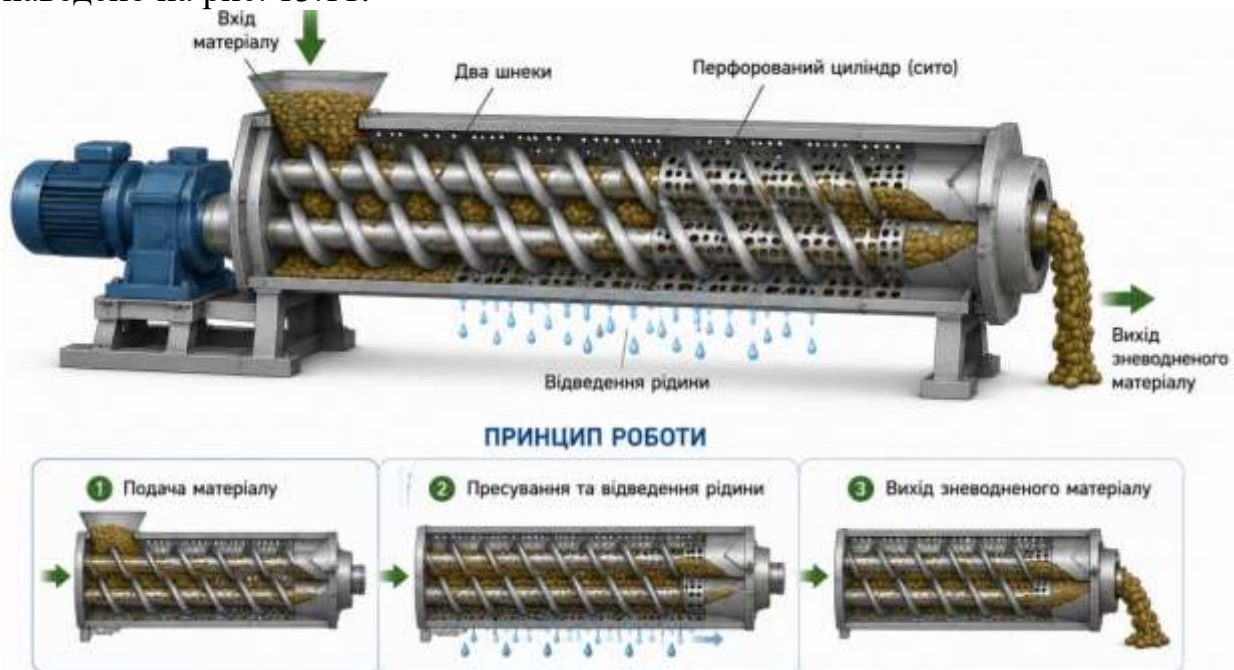
Рис. 13.11. Двошнековий прес та принцип його роботи
