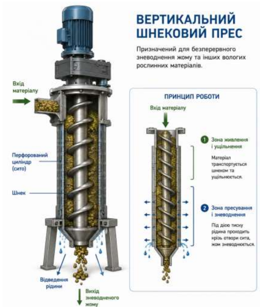
Рис. 13.10. Вертикальний шнековий прес та принцип його роботи
