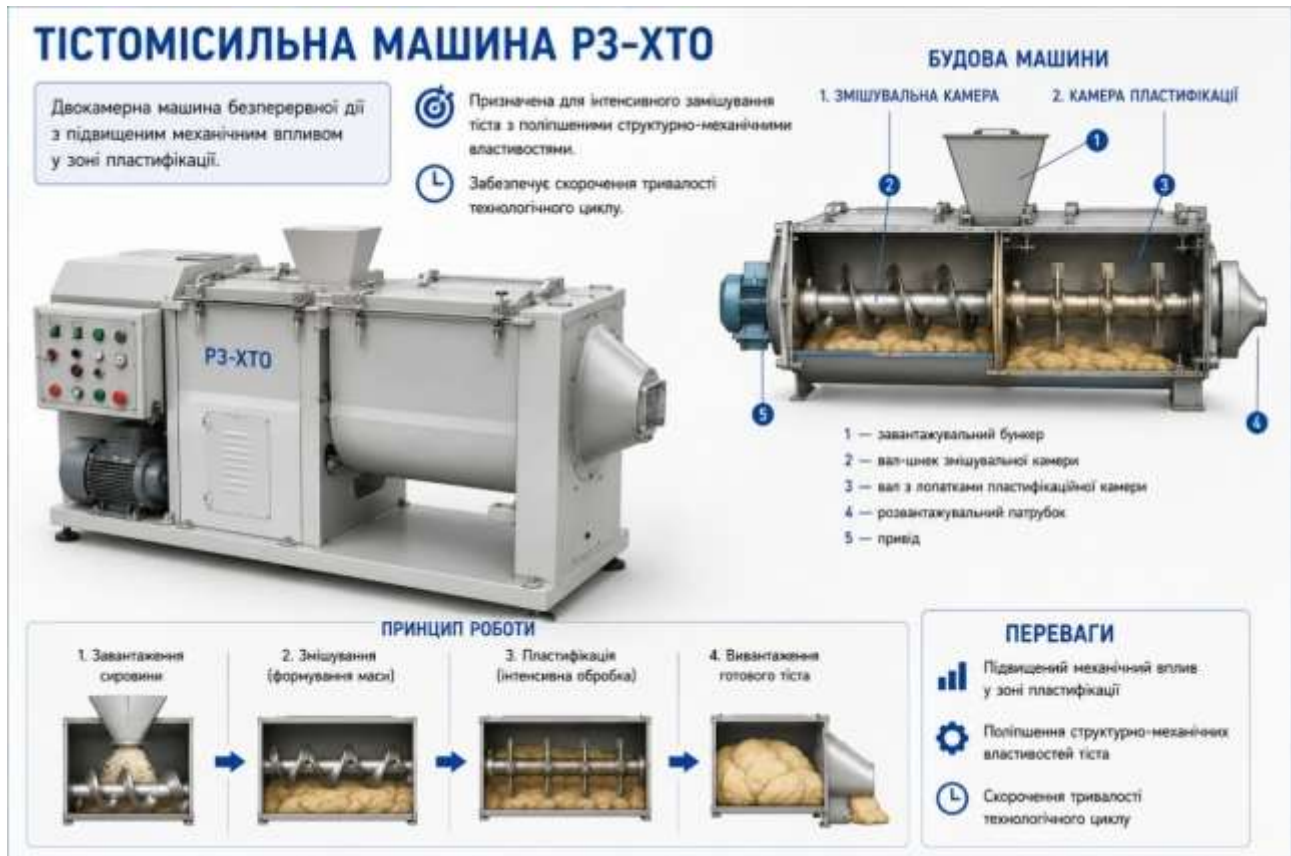
Рис. 10.28. Двокамерна тістомісильна машина безперервної дії РЗ-ХТО
