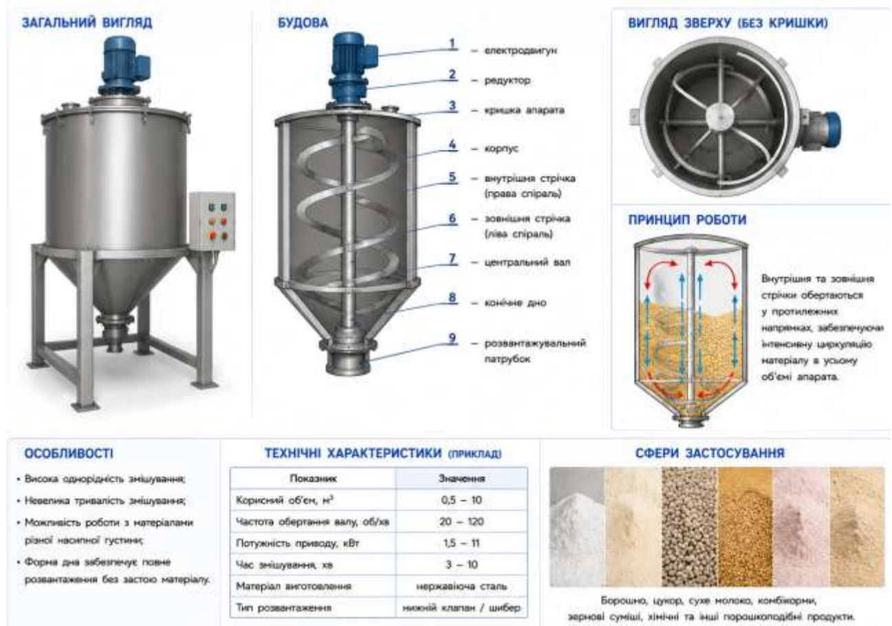
Рис. 10.19. Вертикальний стрічковий змішувач для перемішування сипких матеріалів
