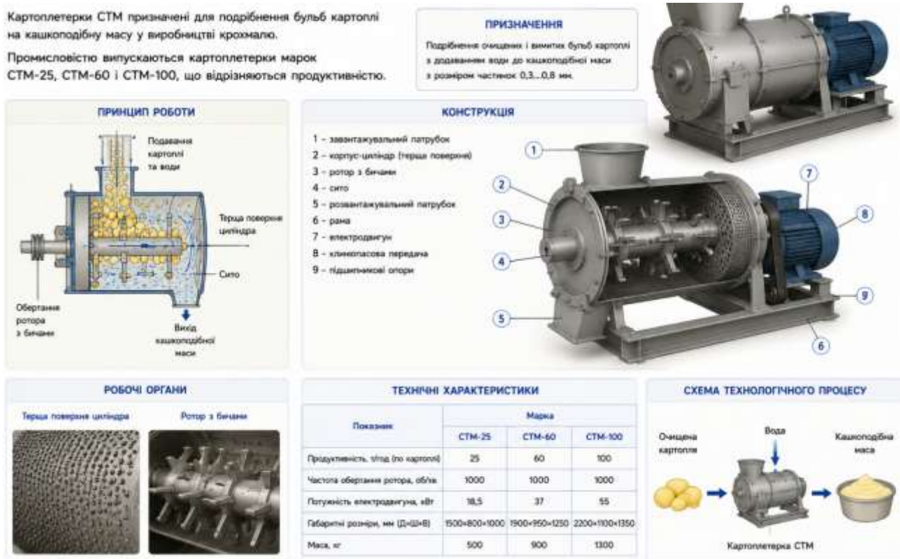
Рис. 9.37. Будова картоплетерки СТМ та схема подрібнення бульб картоплі
