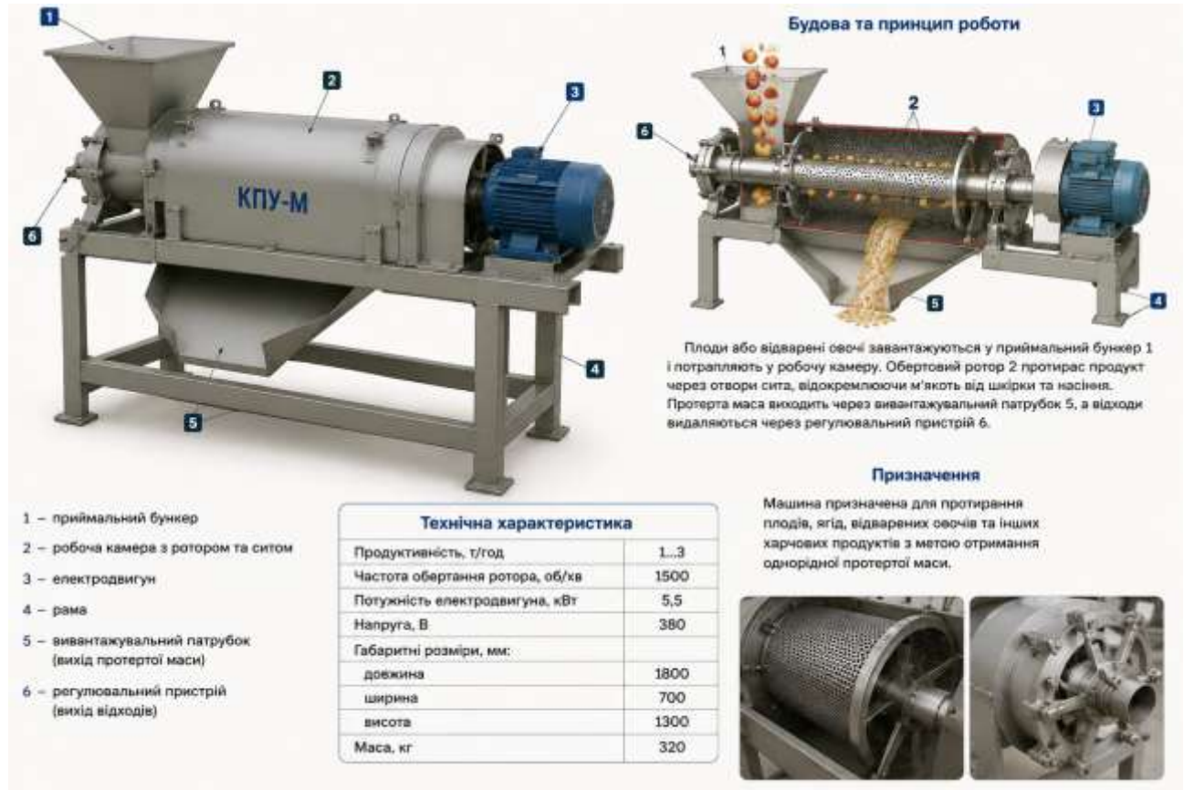
Рис. 7.50. Протиральна машина КПУ-М: будова та принцип роботи
