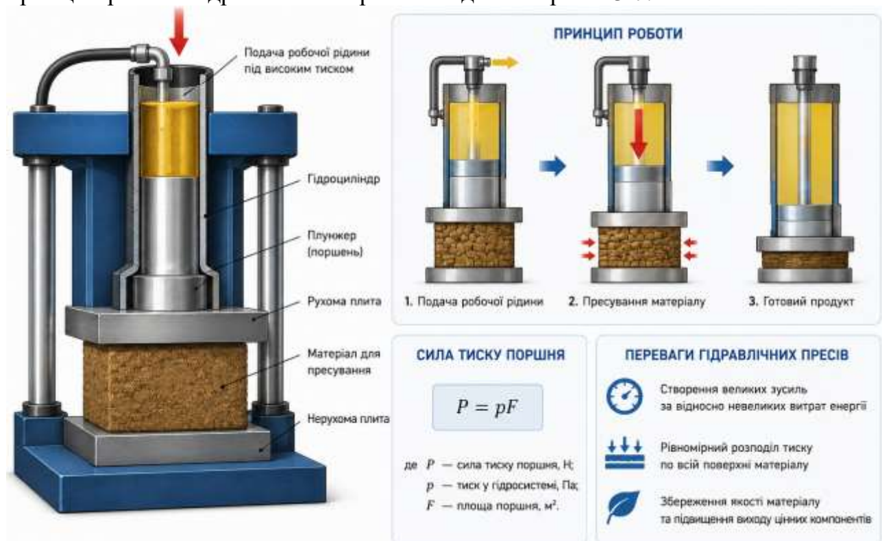
Рис. 13.7. Гідравлічний прес: будова та принцип роботи
