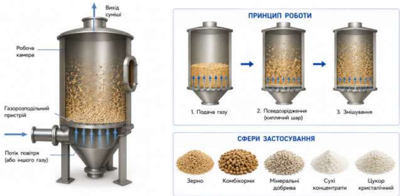
Рис. 10.22. Перемішування сипких матеріалів у псевдозрідженому (киплячому) шарі
