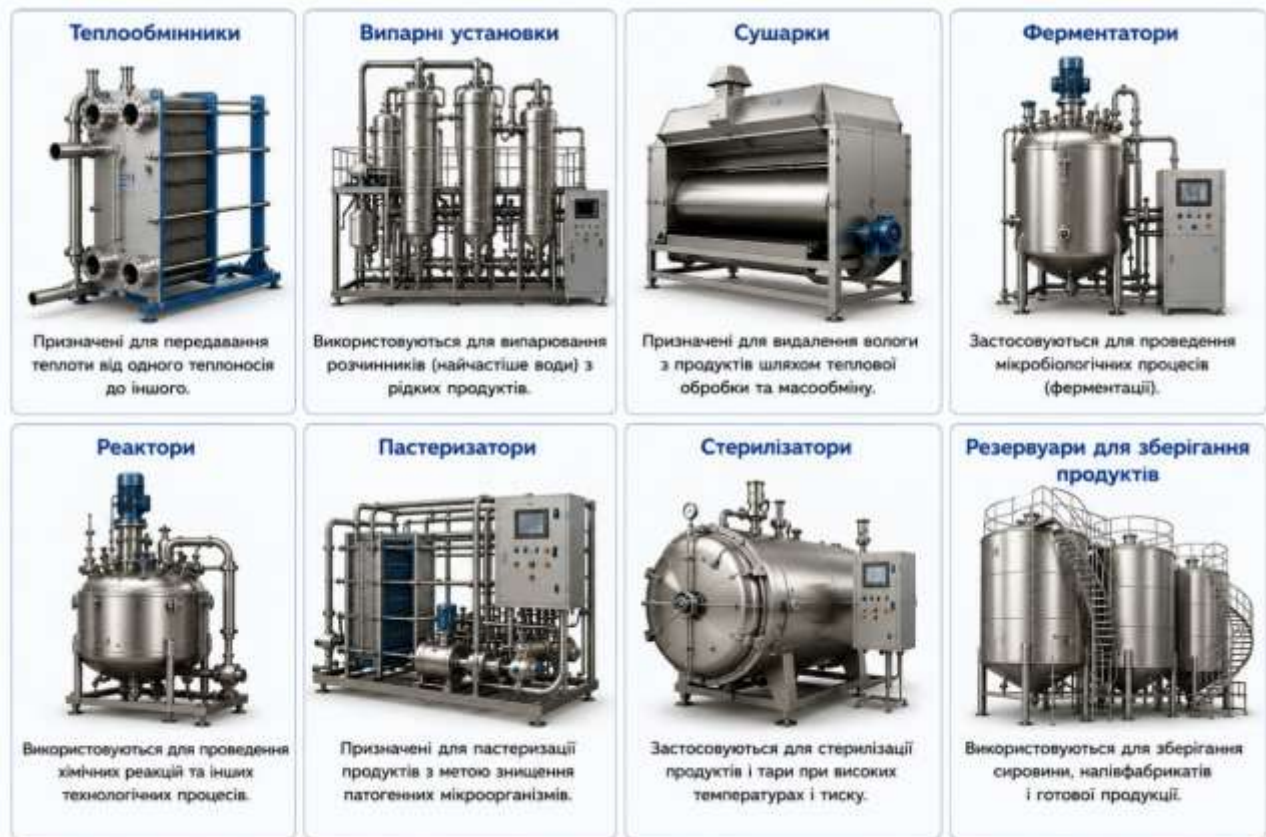
Рис. 2.2. Основні апарати харчових виробництв та їх призначення
