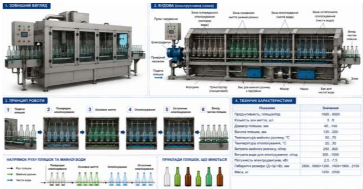
Рис. 6.12. Пляшкочийна машина: зовнішній вигляд, будова та принцип роботи
