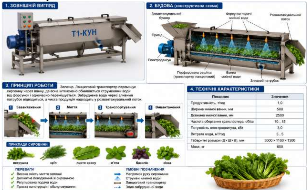
Рис. 5.7. Машина Т1-КУН: зовнішній вигляд, будова та принцип роботи
