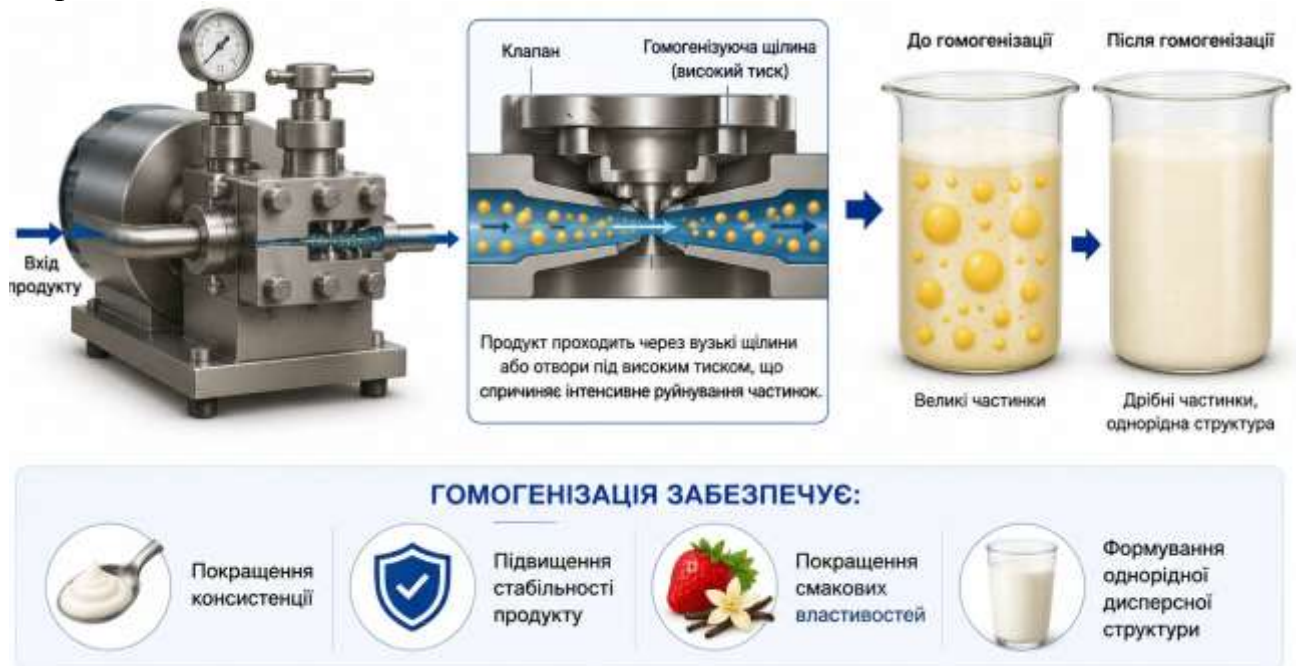
Рис. 9.3. Принцип дії гомогенізатора та вплив гомогенізації на структуру харчових продуктів
